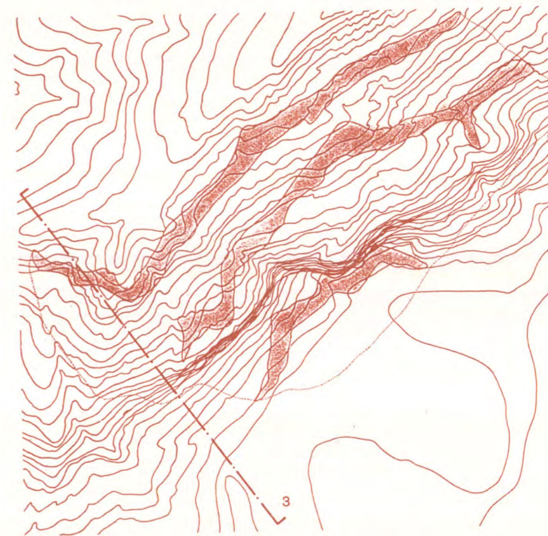
Topografia originària amb l'emplaçament de la pedrera a l'any 1929. E: 1/4.000 (corbes de nivell cada 5 m.).
