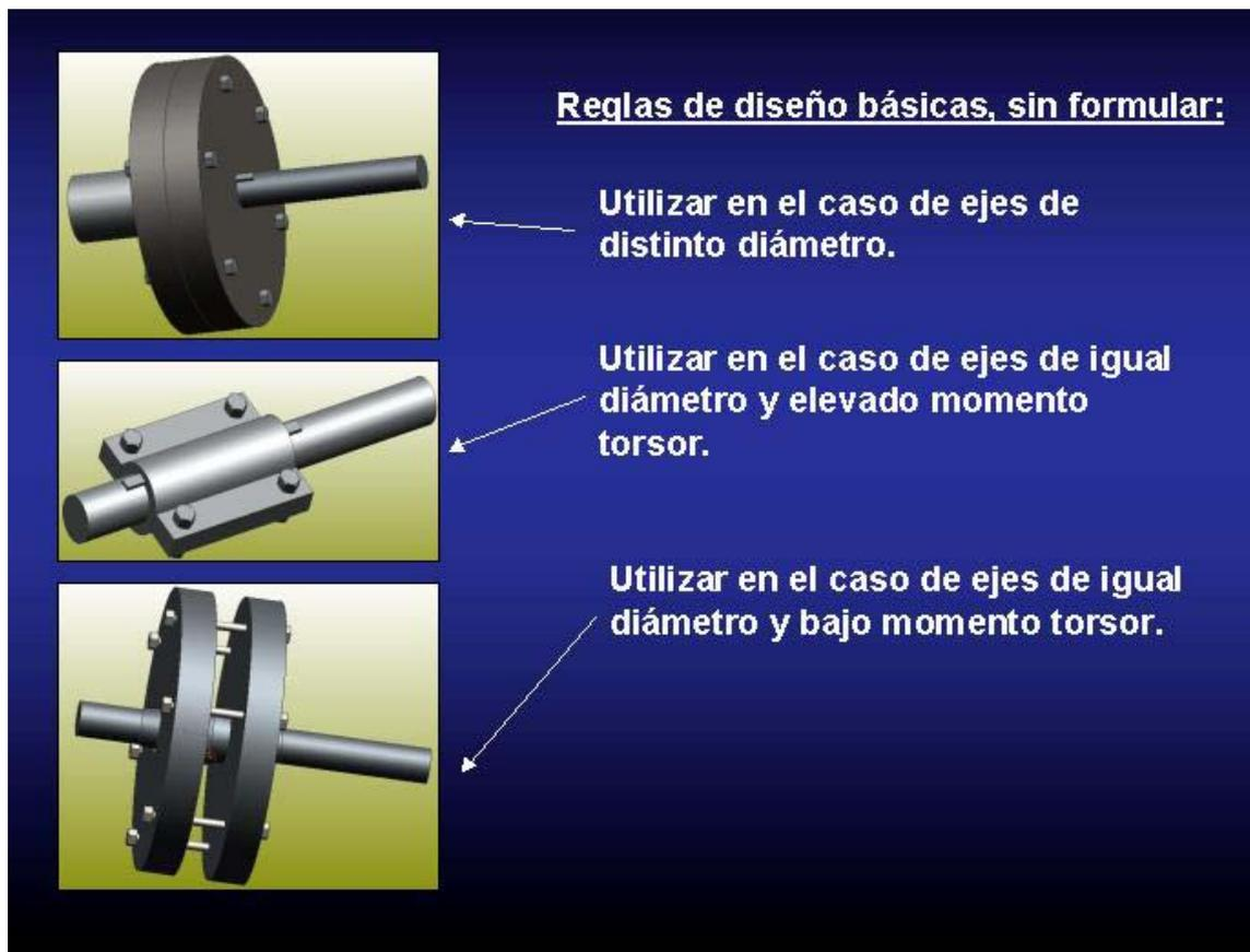
Ilustración 38. Aplicación de reglas de diseño. Sanz Arranz
