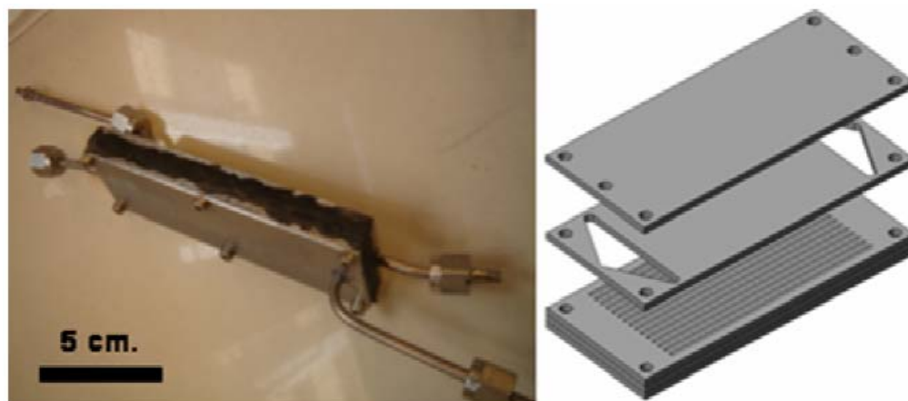
Figura 1.3- Microreactor de dos caras diseñado y construido al Instituto de Técnicas Energéticas de la UPC ([Griffon, 2006], [Casanovas et al., 2008], [Saint-Gerons, 2007])
