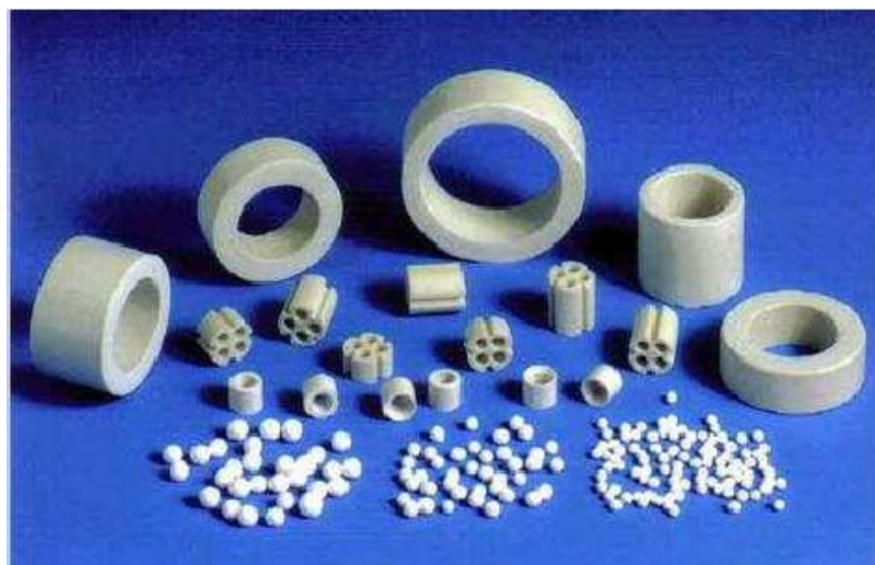
Figura 1.2 - Diferentes formas y tamaños de soportes catalíticos de alúmina.
