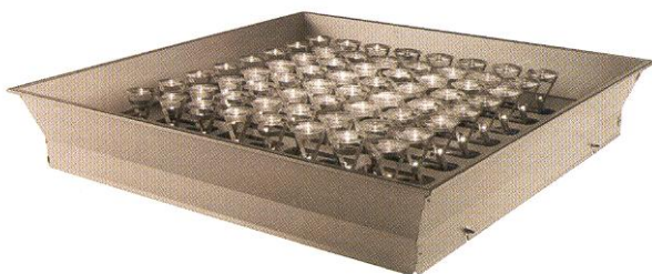
Panel captador de luz natural formado por lentes Fresnel que se orientan con el sol y dirigen la luz a los cables de fibra óptica. Fuente: Tectónica 64 .
