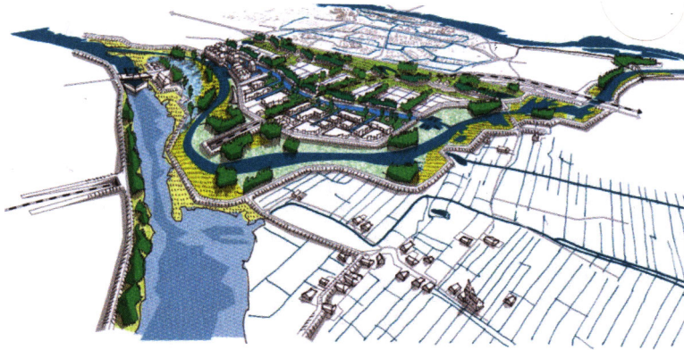
FIG. 20. Uno de los 39 espacios para el Proyecto de los ríos: un by-pass del río cerca de la ciudad de Kampen provee simultáneamente espacio para el río y para la extensión urbana.
