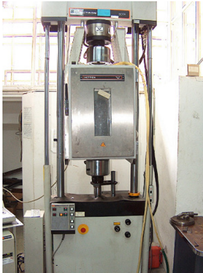
Figura 3.27. Dispositivo experimental para el ensayo de tracción a 450°C.
