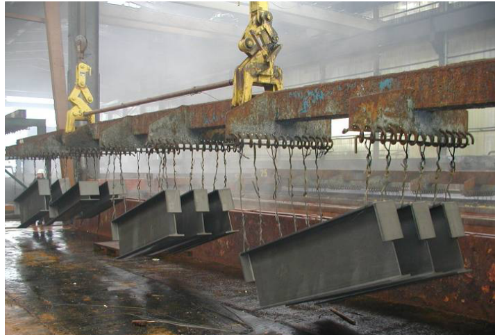
Figura 2.14. Perfiles doble T con semi-placas soldadas en sus extremos dispuestos para ser galvanizados (imagen proporcionada por la empresa Arcelor-Mittal[60]).
