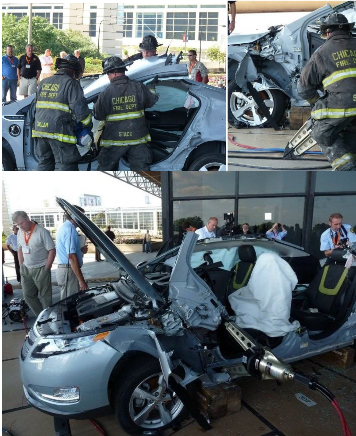
Figura 6-10: Seqüència de maniobres d'excarceració en un vehicle híbrid als estats units (Detroit FD i GM)
