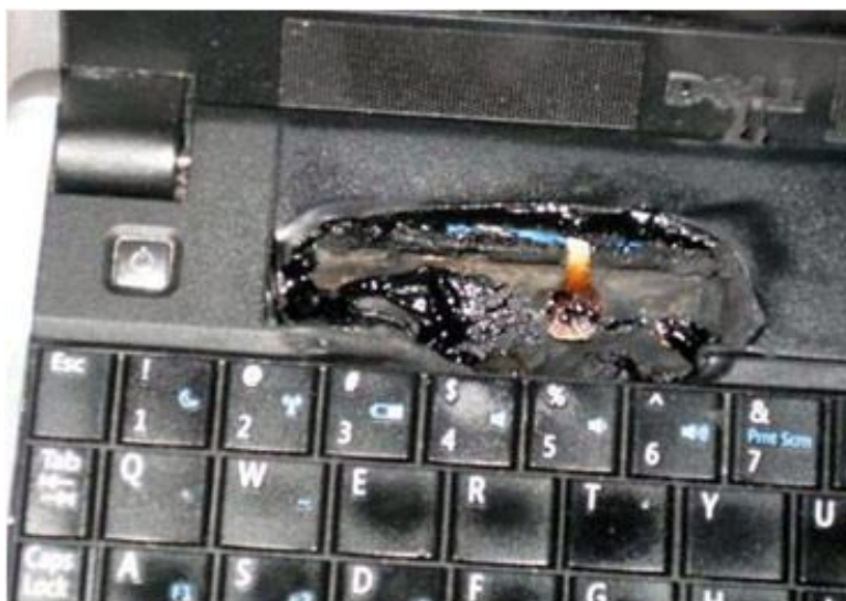
Figura 6-15: Exemple de sobrecàrrega: una cel·la LCO es reescalfa, rebenta, es desinfla i algunes guspines volen pocs cm.
