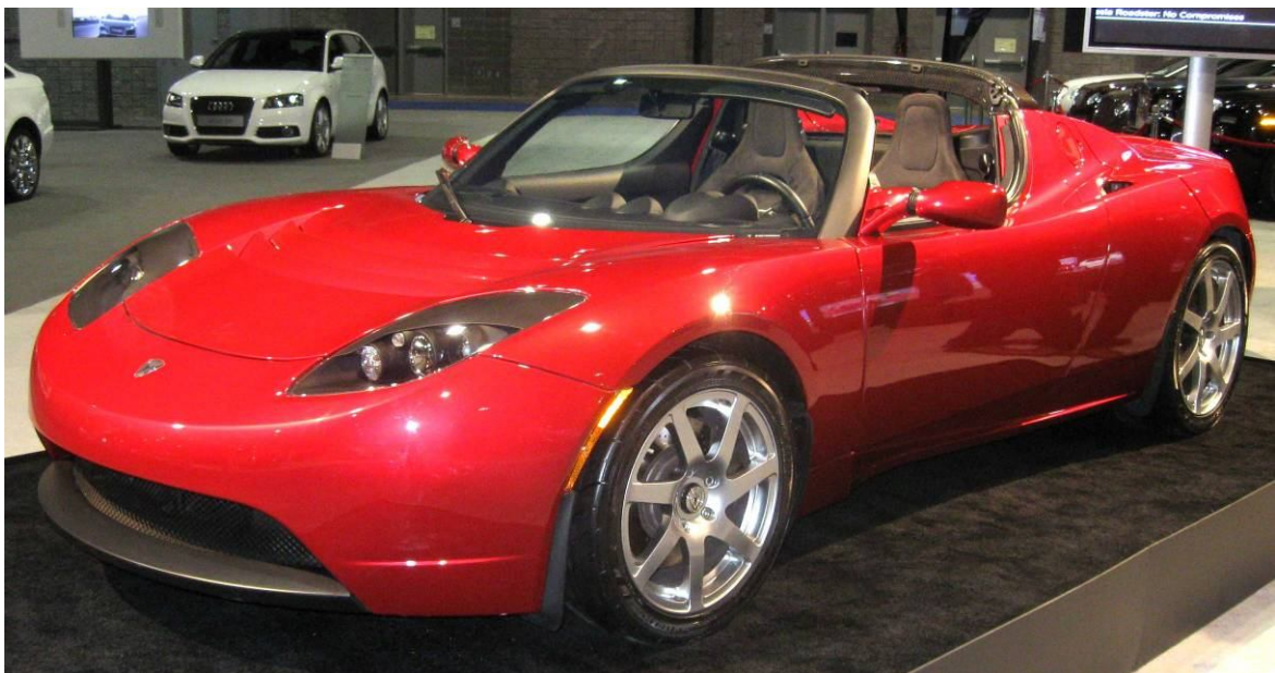
Figura 5-12: Vehicles com el Tesla Roadster munten 6800 cel·les mida 18650 de LiCo (Tesla.com)
