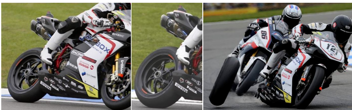
Figura 15-1. Exemple de fallida en llanda d'aliatge (cortesia de Linden Adams, SBK Donington Park 2011)
