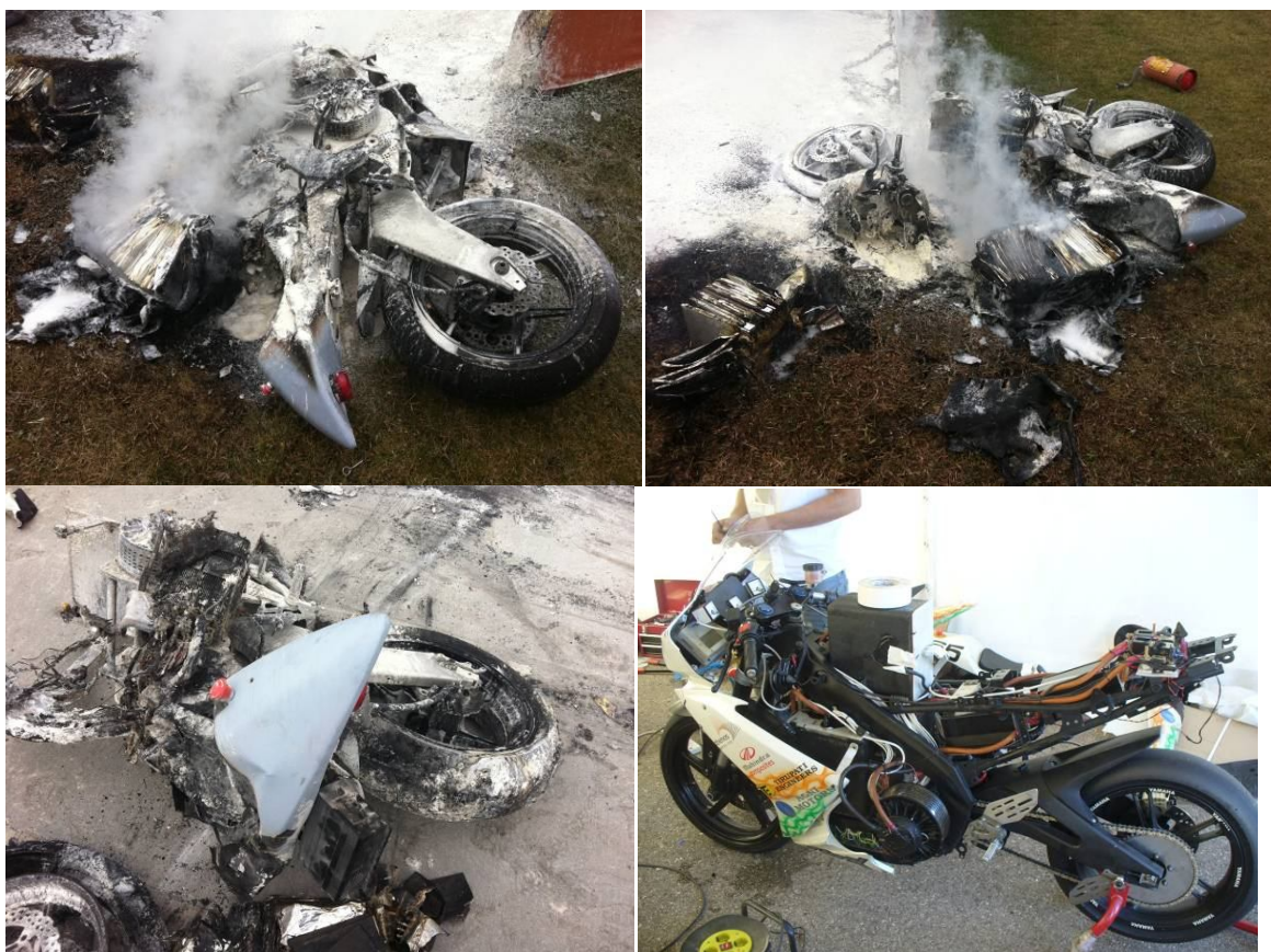
Figura 6-8: Exemple d'una moto que no incorporava sensors de temperatura ni fusibles intermedis en cap dels blocs de bateries de NMC (2010)
