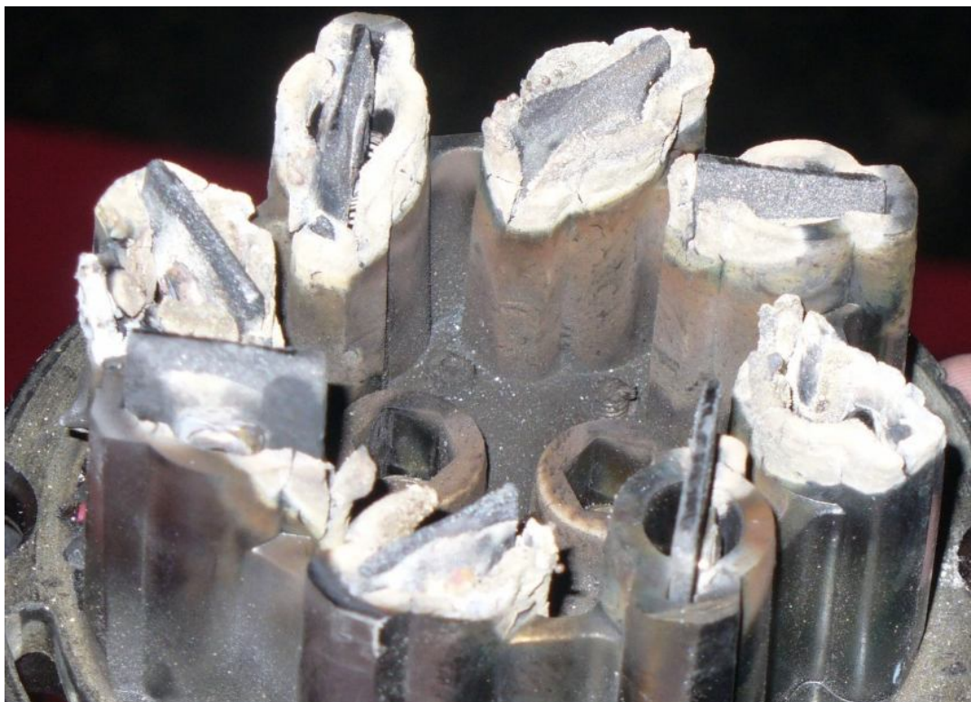
Figura 6-9: En motors amb escombretes, els perills dels arcs voltaics interiors creen problemes de temperatura
