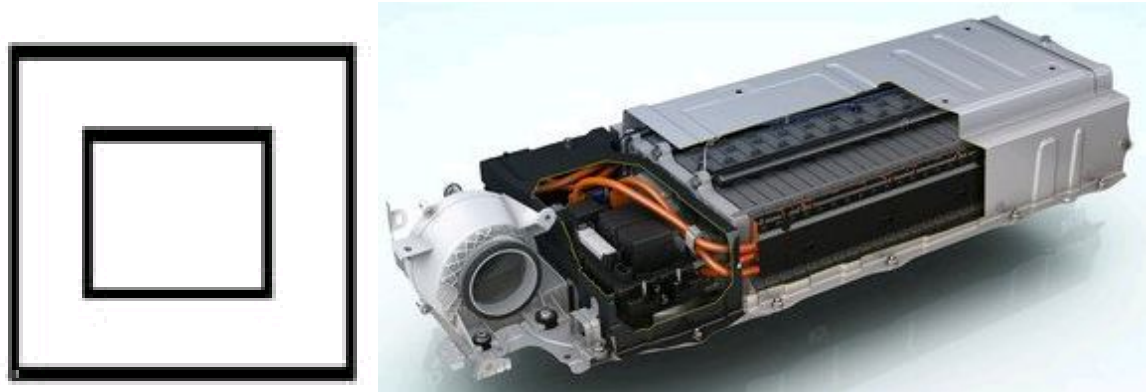
Figura 6-5: Símbol del doble aïllament elèctric i bateria amb doble aïllament ( http://img.motorpasion.com )
