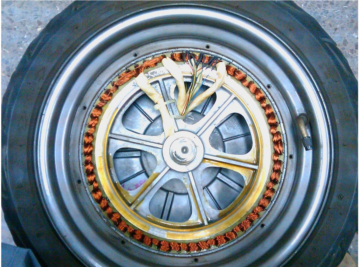
Figura 7-3: Motor a roda (Wheel Hub Motor WHM) d'estructura polar 63/56
