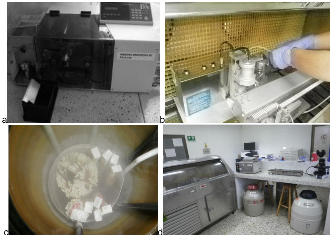
Figura 29. Marcaje, empackado y congelación. a. Máquina marcadora de pajillas. b. Máquina empacadora y selladora de pajillas. c. Semen congelado. d. Vista general del laboratorio de andrología del CRIA CI la Libertad de Corpoica.
