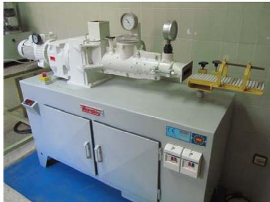
Figura 2.8. Extrusora piloto (Verdés, Modelo 050 C)
