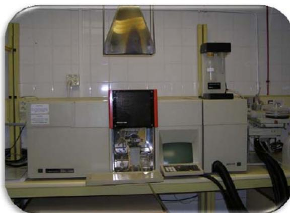
**Figura 2.21. Espectrofotómetro de absorción atómica (Perkin Elmer, Modelo HGA 700)**
