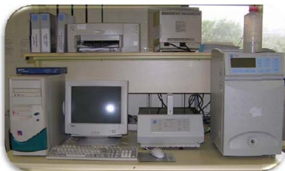
**Figura 2.22. Cromatógrafo Iónico (Dionex, modelo DX-120)**
