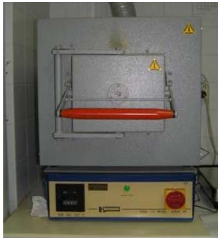
Figura 2.7. Mufla de laboratorio (Hobersal, Modelo 12 PR/300)
