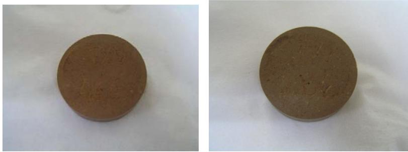
**Figura 4.11. Piezas prensadas con 15 y 20 % de escoria Waelz**
