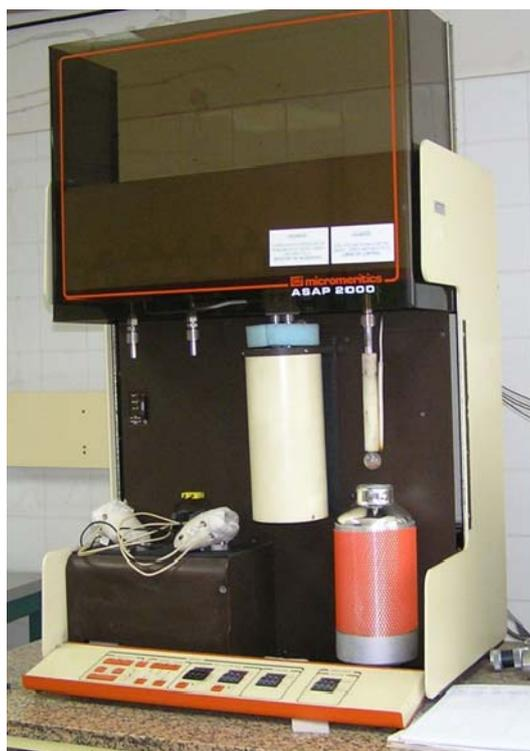
Figura 2.2. Adsorción de Nitrógeno (Micromeritics, modelo ASAP 2000)
