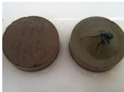
Figura 4.6. Piezas cerámicas que contienen 40 % de escoria Waelz, 9 % humedad y prensadas a 50 bares
