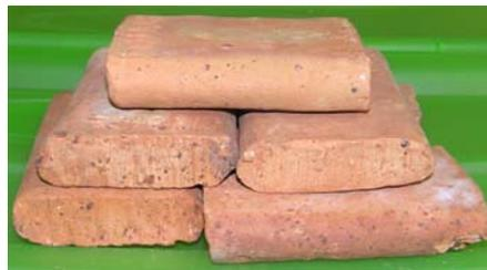
Figura 2.11. Piezas realizadas a escala piloto y cocidos en horno industrial
