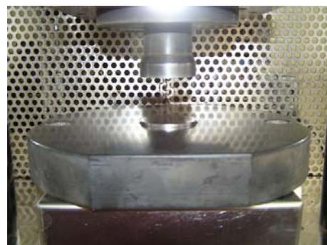
Figura 2.5. Prensa hidráulica y molde (Nanetti, Modelo Mignon SS/EA)
