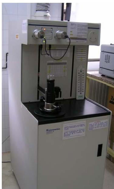
Figura 2.15. Porosímetro de mercurio (Micromeritic, modelo AutoPore IV, tipo 9500)
