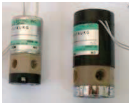
Figura 3.3 Válvulas solenoide externas Takasago.
