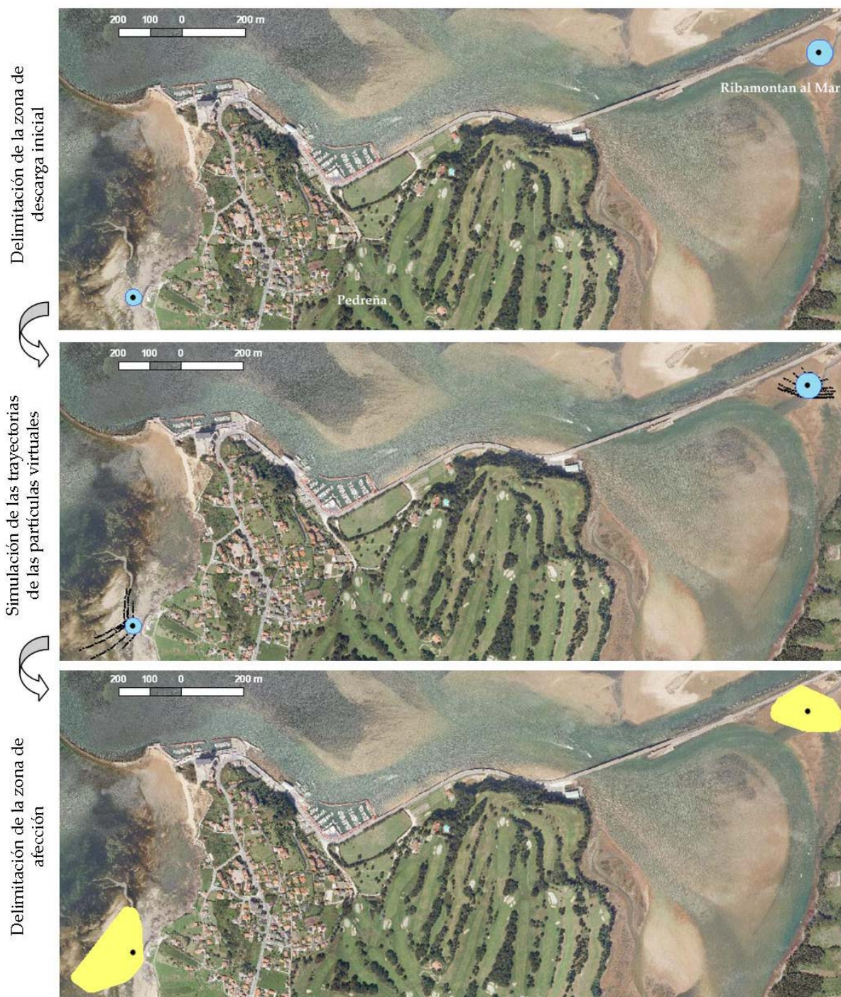
Figura VI. 37. Resultados de las principales etapas del procedimiento de delimitación de la zona de afección de los vertidos acuáticos puntuales en la Bahía de Santander.
