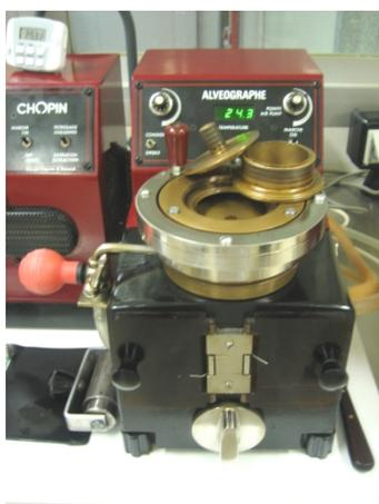
**Figura 13.** Imagen de la platina de salida de aire que forma parte del alveógrafo. En esta imagen se observa el receptáculo en el que se coloca el pastón de masa panaria para ser hinchada.
