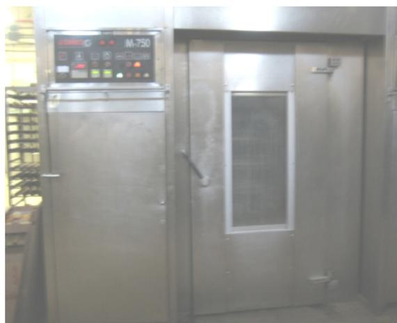
**Figura 18.** Horno de aire. Fuente: Elaboración propia
