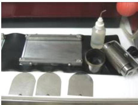
**Figura 10.** Material para el tratamiento de los pastones (de izquierda a derecha): las placas de vidrio, la vaselina, el molde circular y el rodillo.
