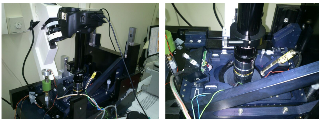
Figura 4.2. Imagen del microscopio óptico montado sobre el SFM para poder observar muestras opacas en reflexión o para iluminar en transmisión a través del objetivo. En la imagen de la izquierda se puede ver el sistema completo que va desde el objetivo hasta la cámara que detecta la imagen. A la derecha se muestra un detalle en el que se aprecia como se sitúa el objetivo sobre el SFM a la distancia de trabajo adecuada para focalizar la micropalanca. Se puede observar que a esa distancia tan próxima no se puede colocar el condensador del microscopio por tener un mayor diámetro que el objetivo.
