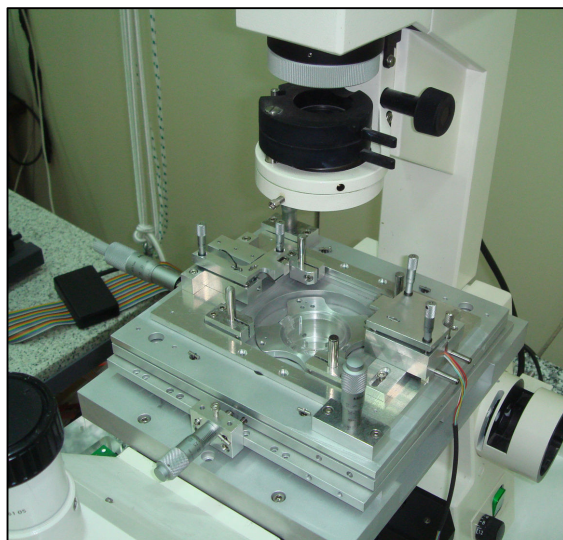
Figura 3.3. Imagen del primer SFM construido montado sobre el microscopio óptico Axiovert 100A de la marca Zeiss.
