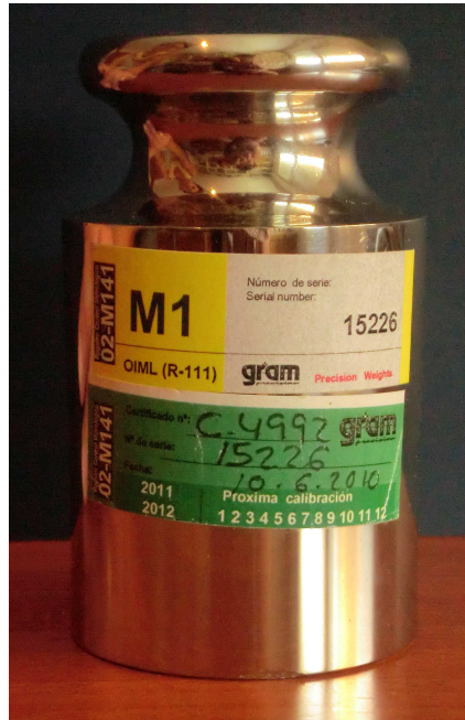
Figura 35. Masa de 1 kg que se utilizó para la calibración de los sensores Flexiforce ®.
