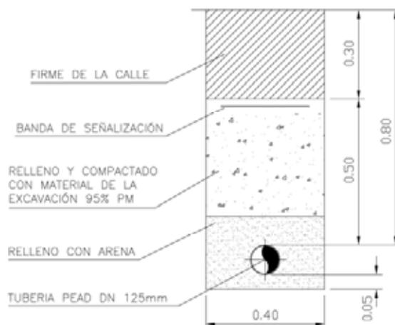
Figura núm. 6-15: Zanjas tipo, para canalizaciones de gas natural con tubo PEAD de Ø 125.
