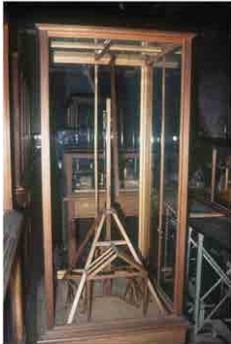
Fig. 11. Model of the telegraph with oblique telescopes. Musée des arts et métiers (Paris).
