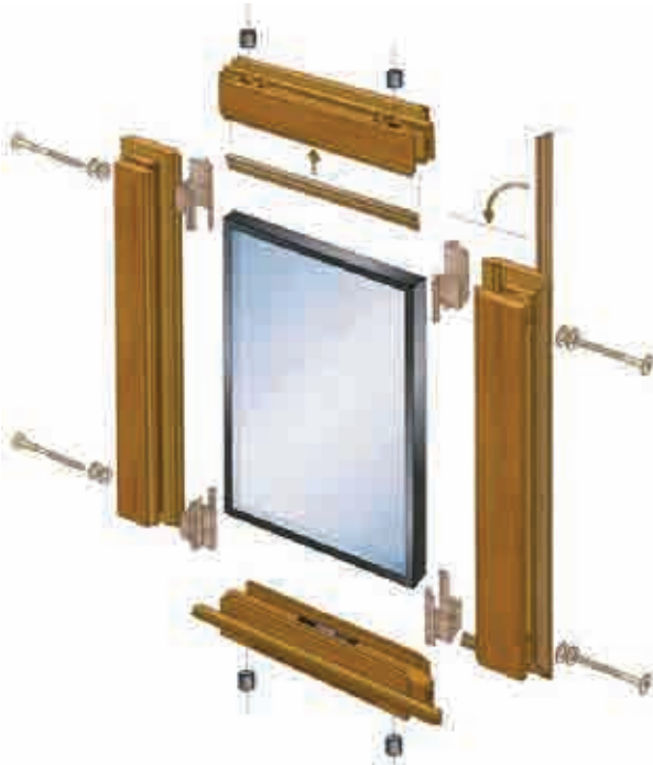
Fig.4.7. Elementos que conforman una ventana de madera
