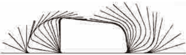
Fig.D2.17. Desarrollo de la sección para perfil de sección cerrada mediante la técnica del 'Rollforming'. Tecnalia
