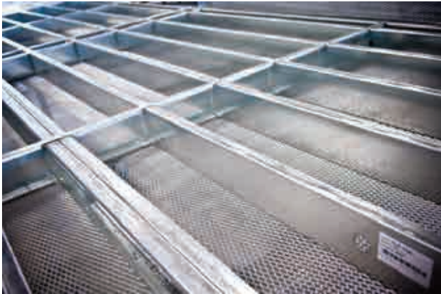
Fig.3.43. Bastidor con el deployeé de conexión con el hormigón
