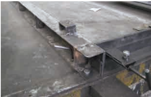
Fig.2.15. Definición geométrica del molde perimetral mediante semiproductos. Empresa Escofet
