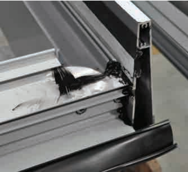
Fig.D5.8. Sellado manual de las esquinas del bastidor.
