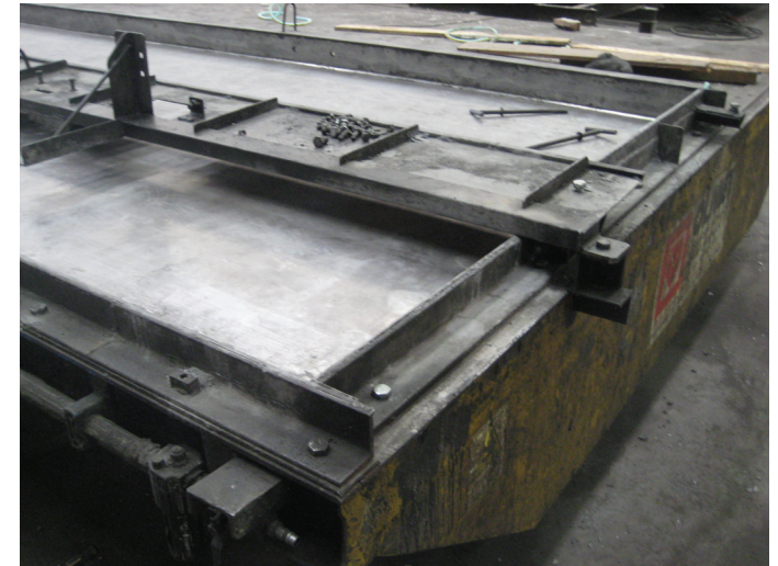
Fig.6.14. Moldes perimetrales preparados para permitir las operaciones de montaje y desmontaje. Durabilidad aproximada entre 100 y 200 usos
