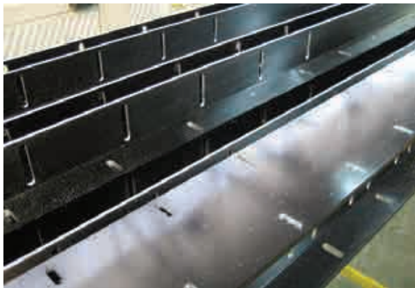
Fig.D3.13- Perfiles de aluminio mecanizados. Folcrá
