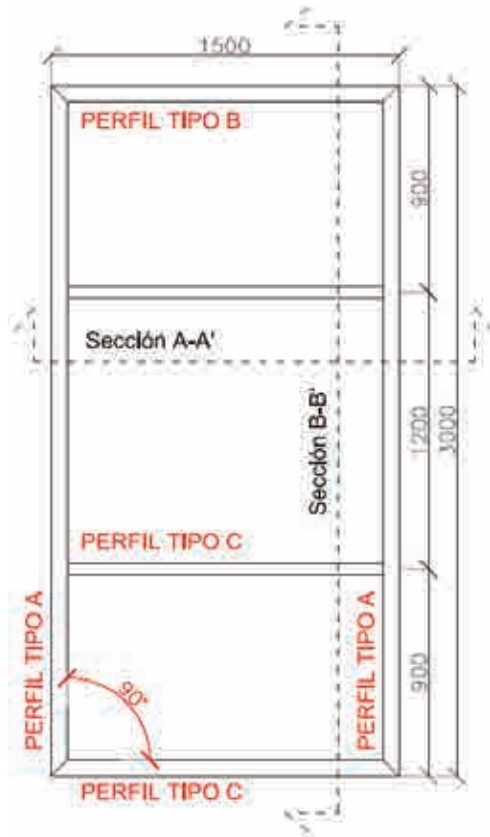
Fig.D5.1. Geometría del bastidor analizado. Ver detalles Anexo 6.
