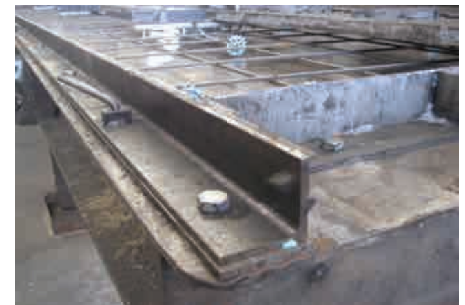
Fig.D1.14. Fijaciones mecánicas para las tabicas laterales
