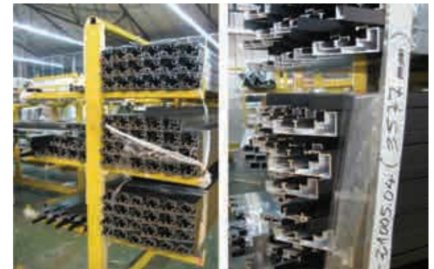
Fig.D3.15- Acopio de perfiles cortados y mecanizados
