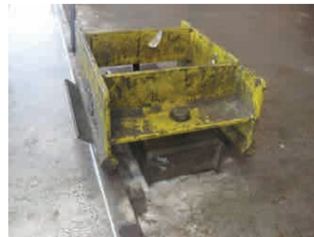
Fig.D4.9. Elemento de conexión entre el imán y el perfil lateral del molde. Empresa Escofet
