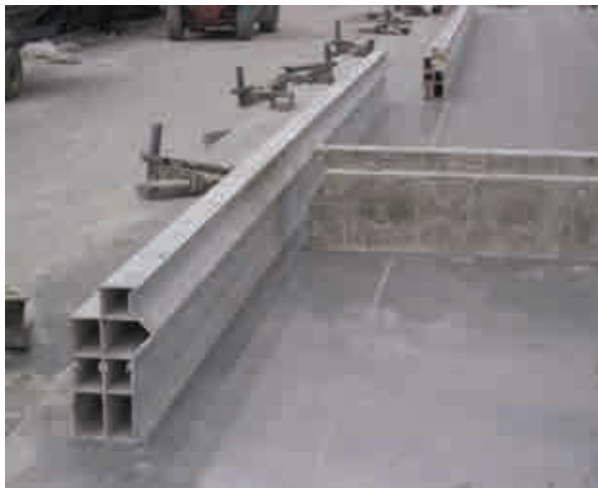
Fig.5.22. Perfiles de aluminio utilizados como moldes perimetrales en la ejecución de elementos de hormigón. Empresa Prefabricados Tecnyconta
