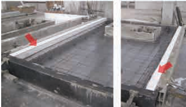
Fig.2.30. La clientalización del molde perimetral a través de la adición de elementos de porexpan. Empresa Tecnyconta
