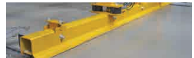
Fig.D1.5. Perfiles de borde conformados de Weckenmann
