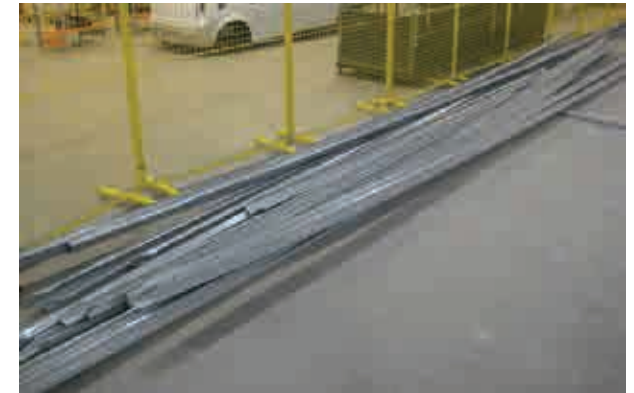
Fig.D2.22. Perfiles conformados con 'Roll Forming' de longitudes variables de entre 8-12m.
