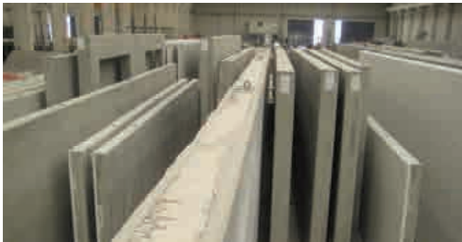
Fig.D1.27. Acopio de paneles finalizados estabilizados mediante sistema de 'peine'. Empresa Tecnyconta
