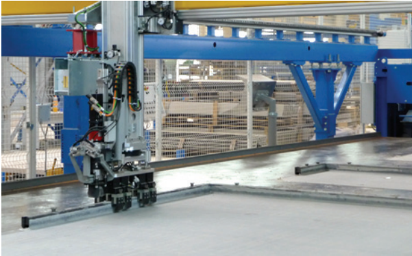
Fig.2.26. Colocación robotizada del molde perimetral con sistema de fijación magnético de la empresa EBAWE
