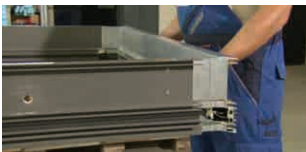
Fig.D3.17- Montaje manual de escuadras y pre-ensamblaje
