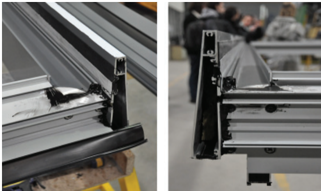
Fig.D3.25- Sellado manual entre perfiles
