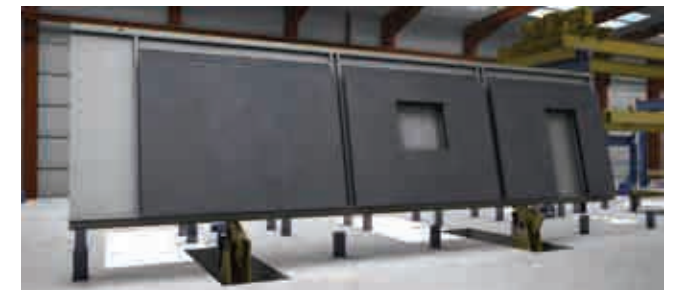
Fig.D1.26. Mesa basculante para facilitar el desmoldeo de paneles. Empresa Weckenmann
