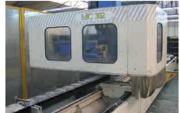
Fig.D3.14- Máquina de mecanizado de perfiles. Folcrá
