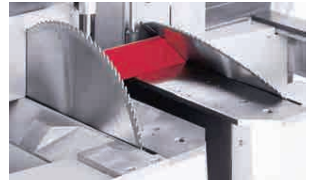
Fig.4.15. Tronzadora de doble cabezal para el corte de perfiles. Empresa Elumatec
