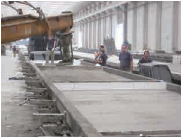
Fig.1.41. Ejecución de un panel de hormigón en fábrica. Tecnyconta
