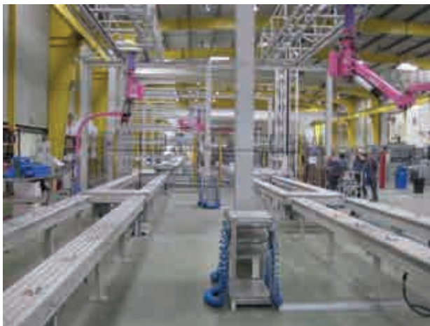
Fig.D3.8- Industria de montaje de módulos para muro cortina. Empresa Technocladd
