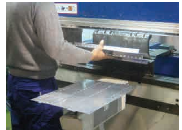
Fig.D2.11. Intervención de la mano de obra durante el proceso de plegado
