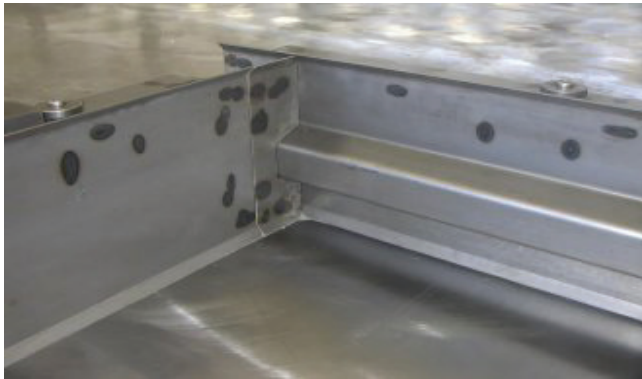
Fig.D1.10. Resolución manual para esquina de molde
