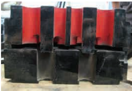
Fig.D2.29. Matriz para extrusión de perfil de sección cerrada
