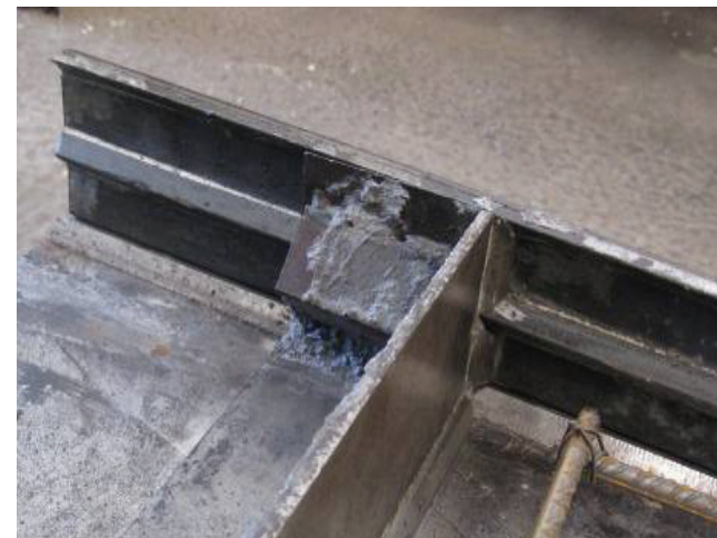
Fig. D4.5. Ensamblaje. Cara interior del molde
