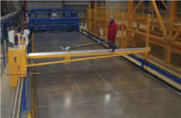
Fig.2.11. Sistema de replanteo mediante plotter de Weckenmann
