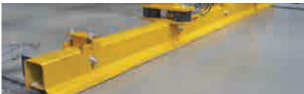
Fig.2.16. Elemento de molde perimetral mediante componente lineales. Empresa Weckenmann
