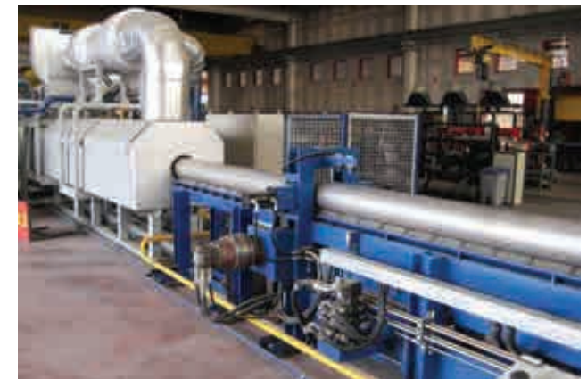
Fig.D2.26. Horno lineal para el pre calentamiento del tocho de aluminio a 400 o 500°C
