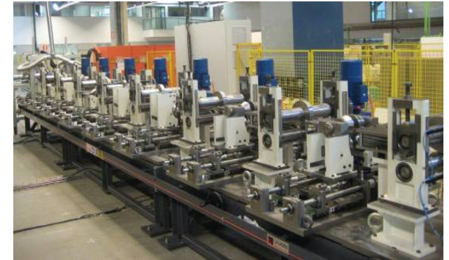
Fig.D2.14. Máquina de perfilado. Tecnalia-Roll Forming.
