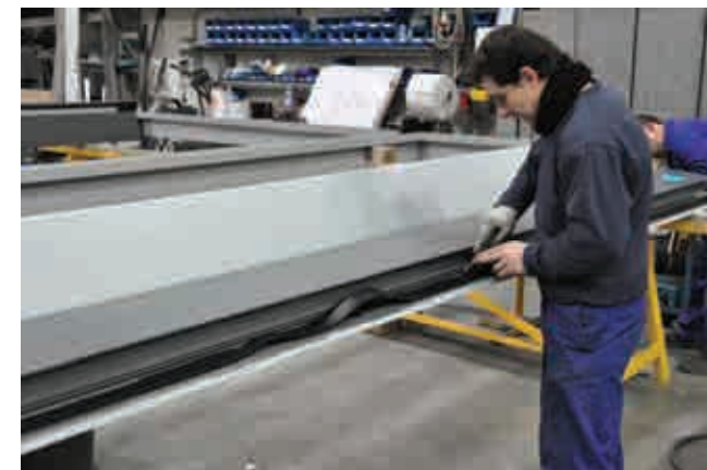
Fig.D5.9. Sellado manual de las esquinas del bastidor. Empresa Folcrá
