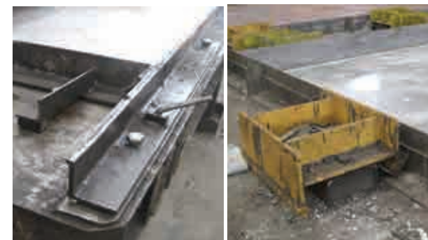
Fig.2.25. Fijación de tabicas laterales con sistemas mecanizados y sistemas imantados
