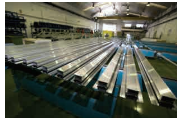
Fig.D3.10- Recepción de los semiproductos lineales, extruidos y tratados superficialmente
