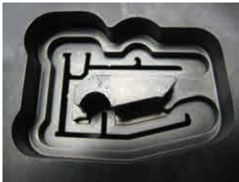
Fig.D2.28. Matriz de extrusión para perfil de sección abierta.
