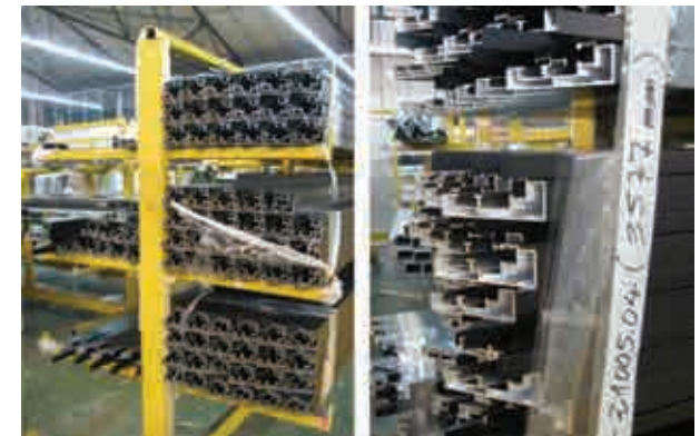
Fig.D3.15- Acopio de perfiles cortados y mecanizados
