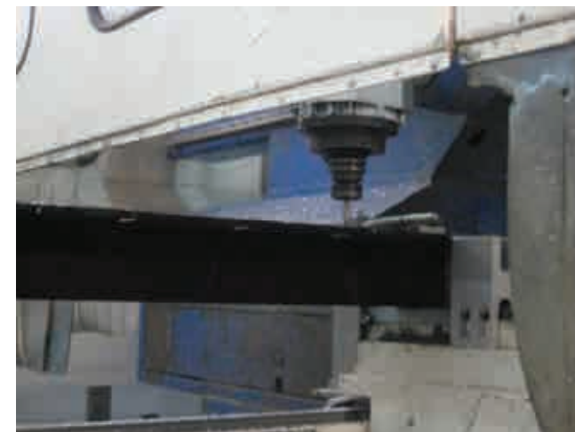
Fig.D5.5. Máquina de corte de doble cabeza. Empresa Folcrá
