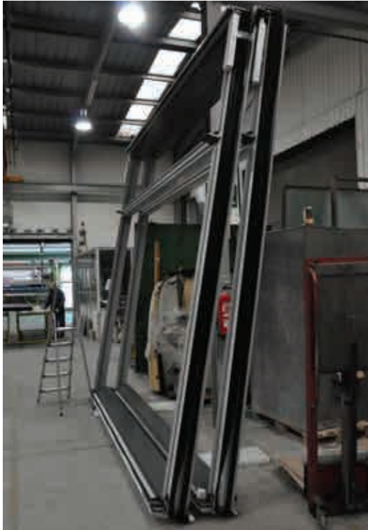
Fig.4.23. Bastidor de fachada finalizado. Empresa Folcrá
