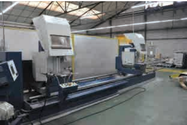
Fig.4.14. Máquina de corte de doble cabeza. Empresa Folcrá
