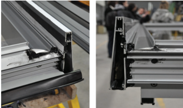
Fig.D3.25- Sellado manual entre perfiles
