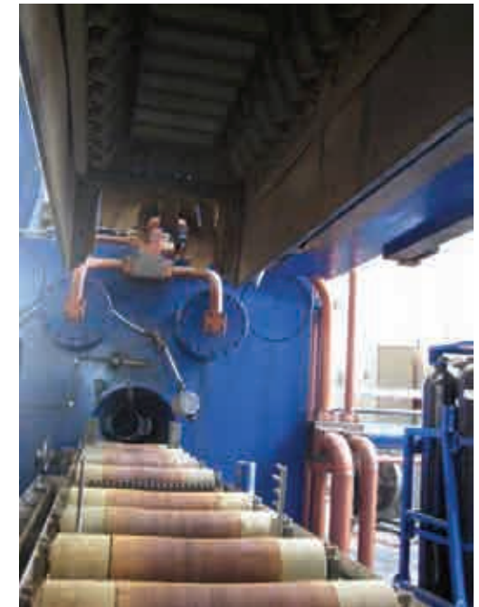
Fig.D2.31. Boca de salida. Enfriamiento progresivo del perfil mediante calor.
