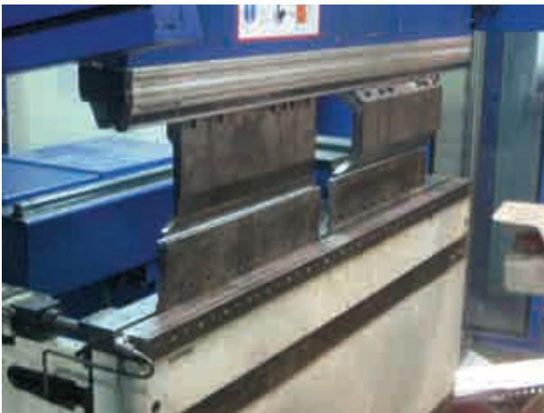
Fig.D2.5. Plegadora hidráulica para láminas individuales
