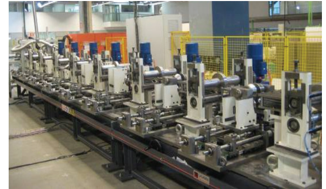
Fig.D2.14. Máquina de perfilado. Tecnalia-Roll Forming.
