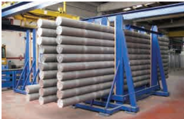
Fig.D2.24. Tochos de aluminio a la espera del proceso de extrusión. Empresa Exal.
