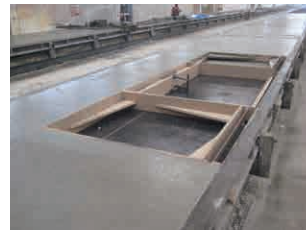
Fig.2.10. Molde desarrollado mediante sistemas manuales. Precon
