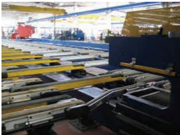
Fig.D2.32. Bancada con mordazas para el estirado y rectificado de la curvatura de los perfiles después de la extrusión
