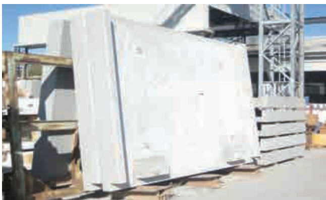
Fig.D1.27. Acopio de paneles finalizados sobre bastidor de soporte. Empresa Escofet
