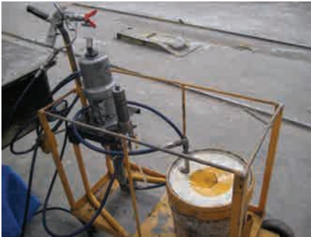
Fig.D4.10. Pistola para el proyectado del desencofrante
