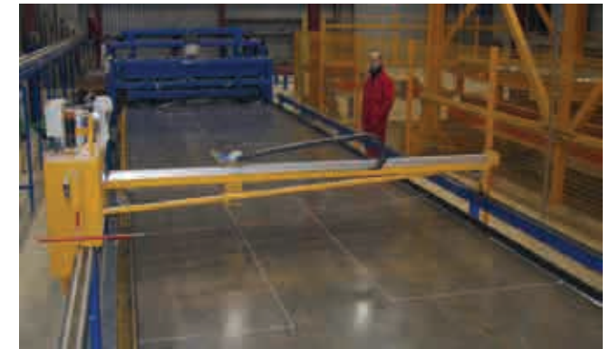
Fig.D1.7. Sistema de replanteo mediante plotter de Weckenmann
