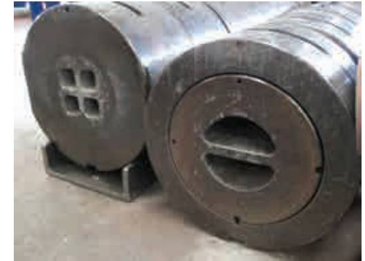
Fig.D2.30. Bolster para el soporte de presiones de la matriz
