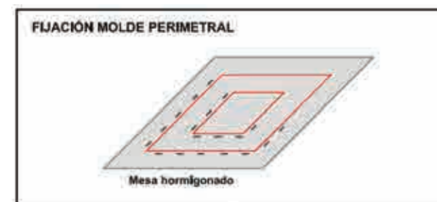
Fig.2.24. Operaciones de fijación de los moldes perimetrales sobre la mesa de hormigonado
