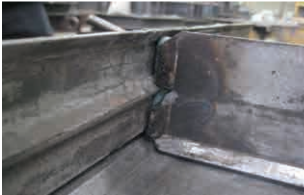
Fig.2.21. Resolución manual para esquina de molde. Empresa Escofet
