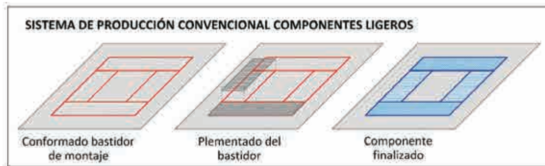
Unitized Modulares de muro cortina. El bastidor forma parte del componente aportándole más funciones.
