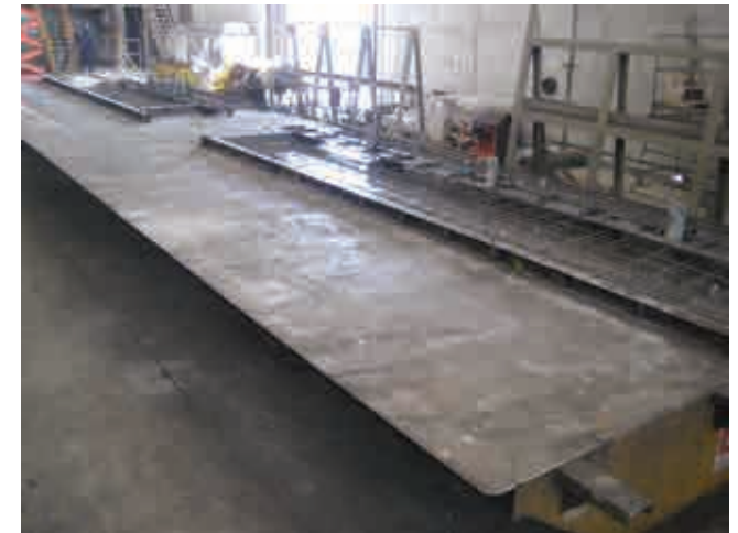
Fig.D1.1. Mesa de hormigonado.
