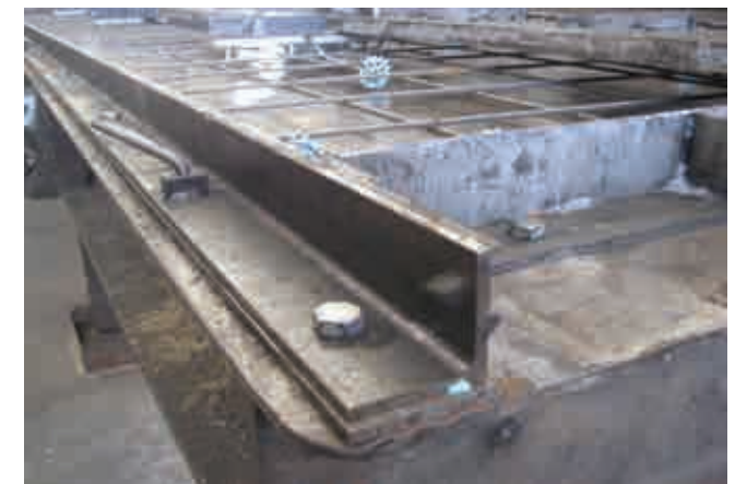
Fig.D1.14. Fijaciones mecánicas para las tabicas laterales
