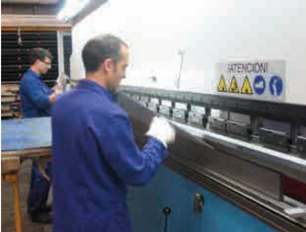
Fig.D2.12. Plegado de elemento de chapa de 2,5m de longitud. Empresa Folcrá
