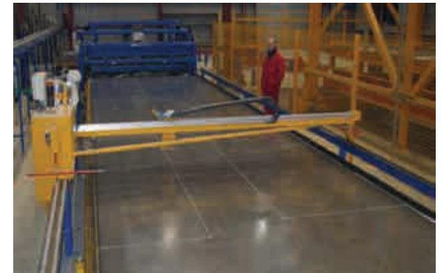
Fig.2.18. Sistema de replanteo mediante plotter sobre la mesa de hormigonado. Empresa Weckenmann
