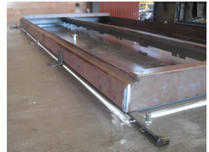
Fig.6.15. Propuesta: Molde perimetral diseñado para un único uso.
