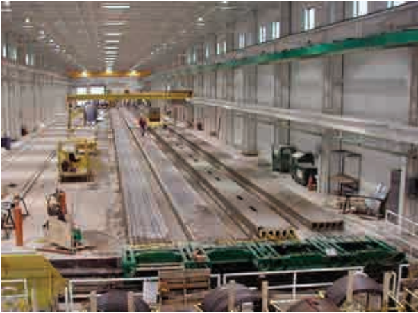
Fig.1.8. Sistema de 'Producción en masa' para placas alveolares de hormigón. Mabeton España S.A.
