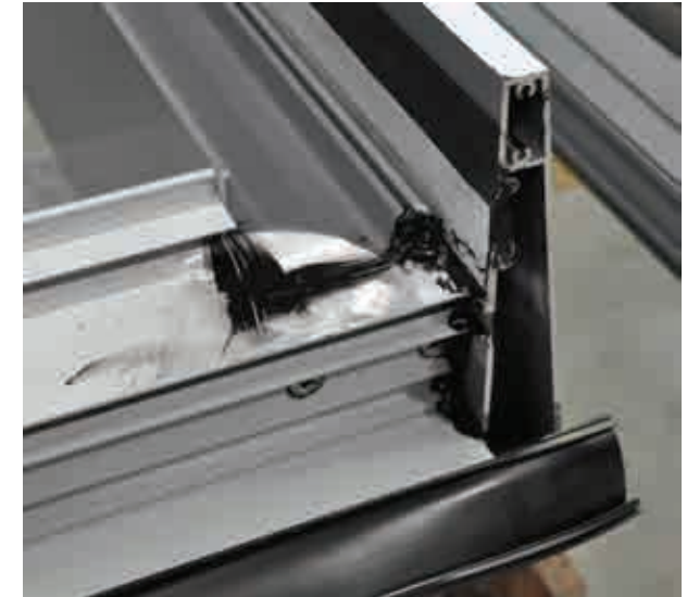
Fig.4.22. Sellado manual de las esquinas del bastidor. Empresa Folcrá
