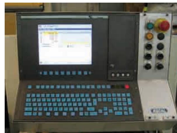
Fig.D3.11- Máquina de CNC para el corte de los perfiles a la longitud deseada
