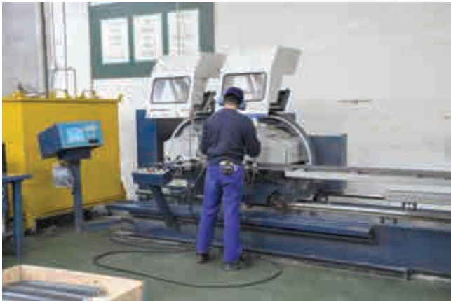
Fig.D5.4. Máquina de corte de doble cabeza. Empresa Folcrá
