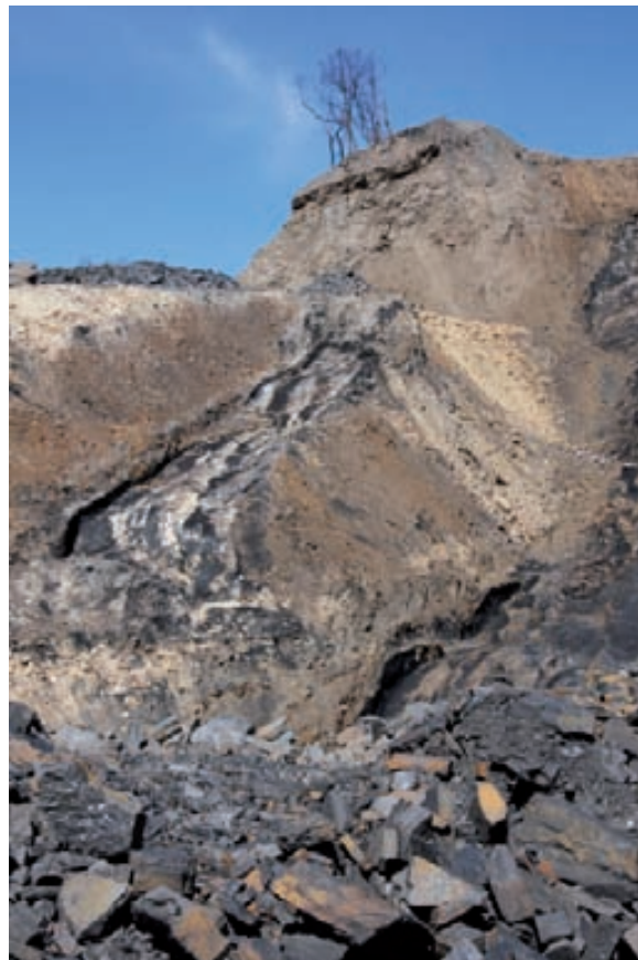
Imagen 11: Corta de El Feixolín (2008) donde se aprecian los procesos de reptación
