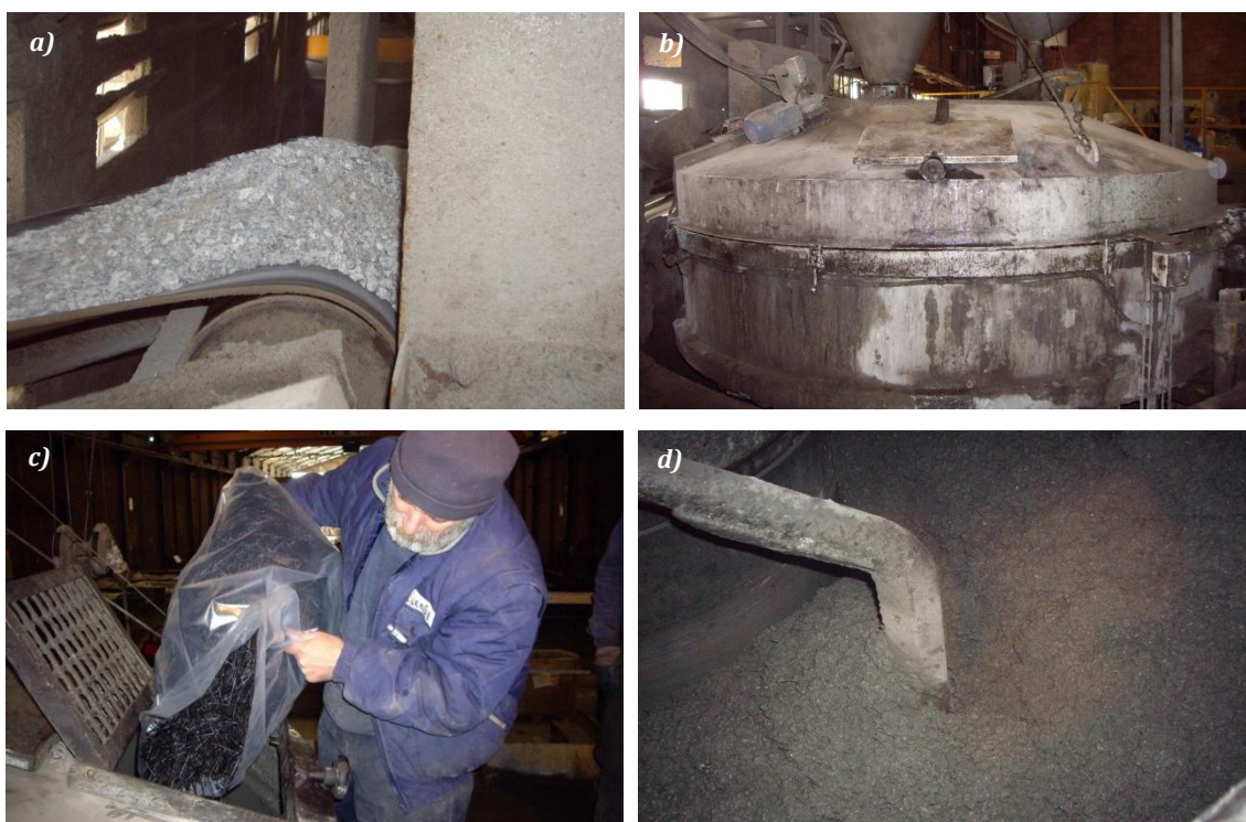
Figura 4.2 – Planta de prefabricados de ESCOFET: a) cinta transportadora; b) amasadora utilizada; c) adición manual de fibras y d) amasado final.
