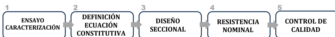
Figura 1.2 –Etapas involucradas en el diseño de estructuras de HRF
