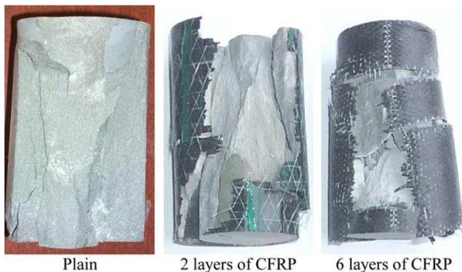
Fig. 2.14 Comportamiento de hormigón confinado y no confinado en sección circular. (Berthet et al.2005)
