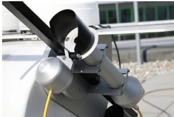
Figura 5.3: Pirheliómetro solar CH-1 con seguidor solar de Kipp and Zonen. Diseñado para tomar medidas automáticas de radiación solar directa
