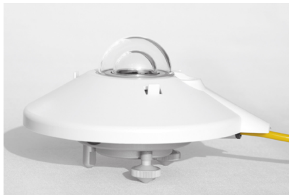
Figura 5.2: Piranómetro solar CMP 21 de Kipp and Zonen. Diseñado para tomar medidas de la radiación solar global, difusa y reflejada
