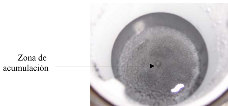
Figura 4.4. Imagen de la disolución en el vaso del reactor con el catalizador en suspensión
