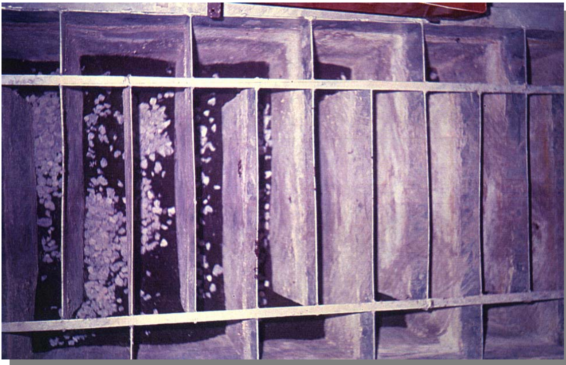
Foto 14.1.a: Relleno del humedal de laboratorio con compost y grava caliza dispersa
