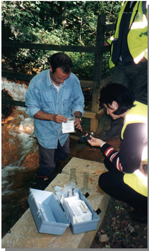
Foto 3.2.2.3.2: Determinación en campo de la alcalinidad de una descarga de agua de mina, mediante el uso del Hach digital titrator model 16900-01
