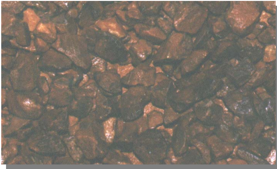
Foto 14.4.c: Depósitos de “ocre” sobre la caliza de la parte superior del sistema ALD
