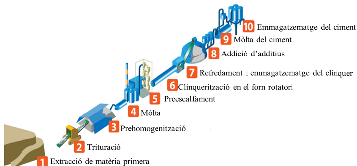
Figura 1.1: Procés de fabricació de ciment (Adaptat de: WBCSD i IEA, 2009).
