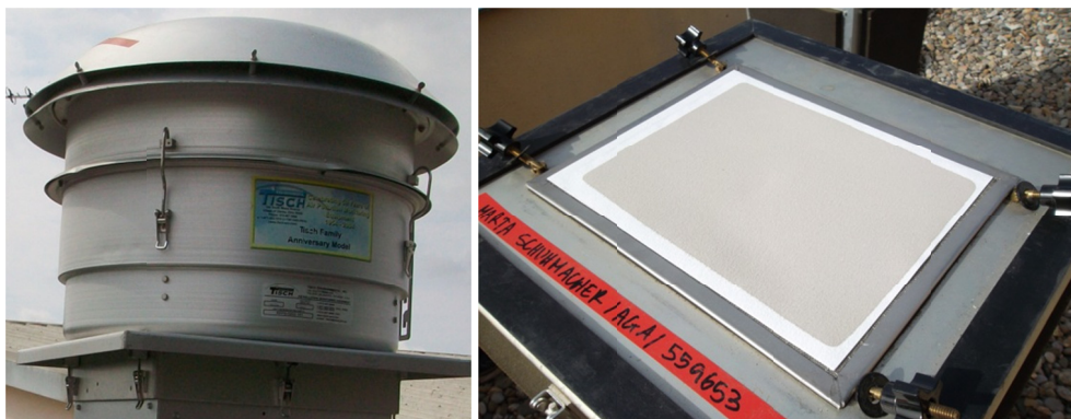
Figura 3.3: A l'esquerra, capçal selectiu de PM 10 del captador d'alt volum 6070-DV. A la dreta, captador sense el capçal selectiu de PM 10 deixant a la vista el QFF.
