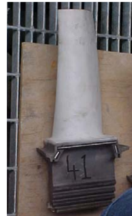
Fig. 1.8. Corona móvil de una etapa de una turbina de gas. Detalle de un álabe.
