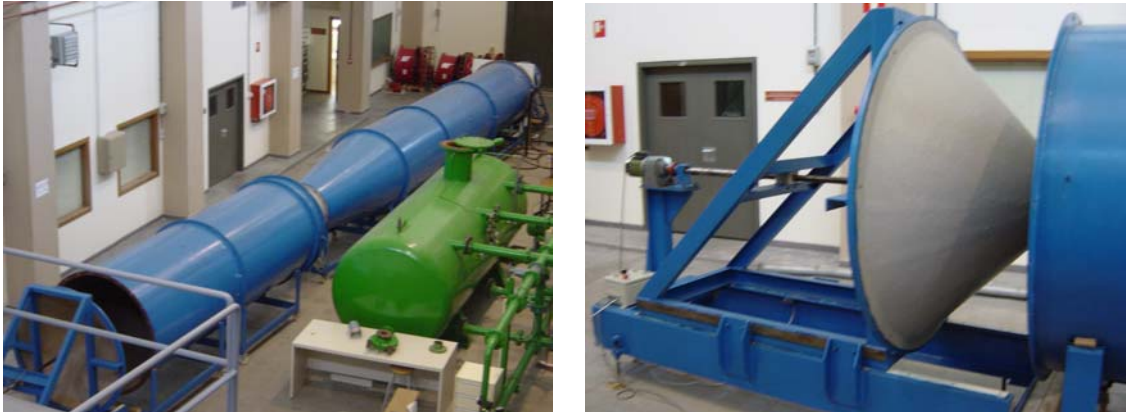
Fig. 3.24. Banco de ensayos: vista del Venturi en zona central. Detalle del cono de regulación.
