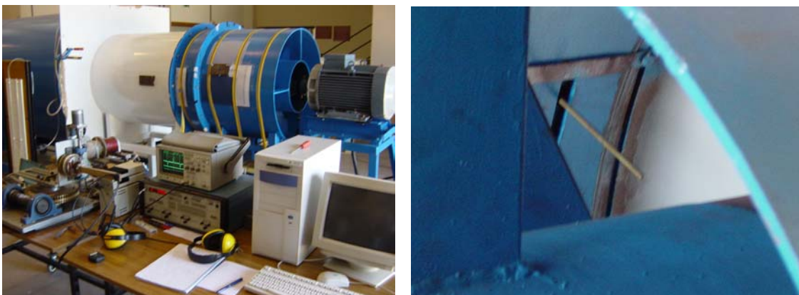
Fig. 3.27. Cadena de medida en laboratorio. Imagen de la sonda en el interior de la soplante.
