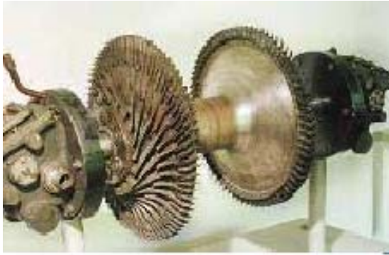
Fig. 1.3.1. Turbina de Elling de 1924. Compresor radial y turbina axial.
