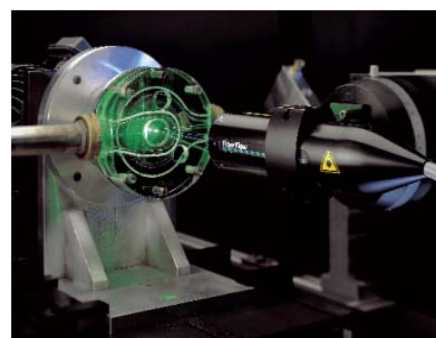
Fig. 3.9.2. Medidas LDV sobre una bomba.
