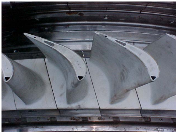
Fig. 1.8. Corona móvil de una etapa de una turbina de gas. Detalle de un álabe.
