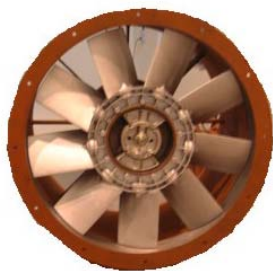
1.7.1. Rotor de ventilador
