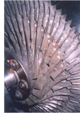
Fig. 1.3.2. Detalle del compresor radial de la turbina de Elling – 1924.
