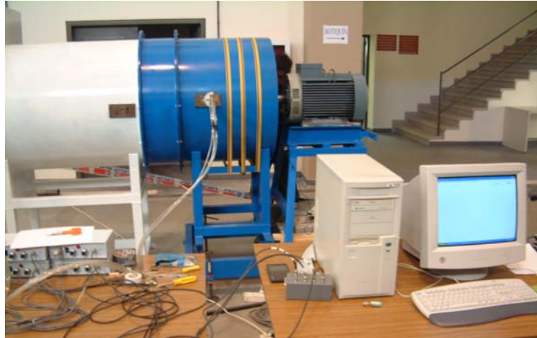
Fig. 3.7.3. Montaje de la cadena de medida completa para sonda direccional de 5 agujeros en un punto situado aguas abajo del rotor.
