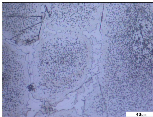
Figura 5.9 Acero alto en cromo austenizado a 1.100°C-1h (500x)
