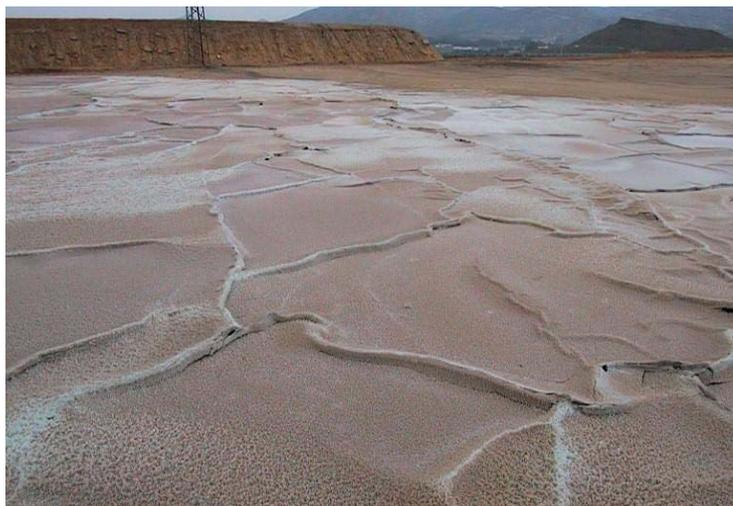
Figura 8.13.- Sales hidratadas precipitadas sobre la superficie de la balsa de residuos.
