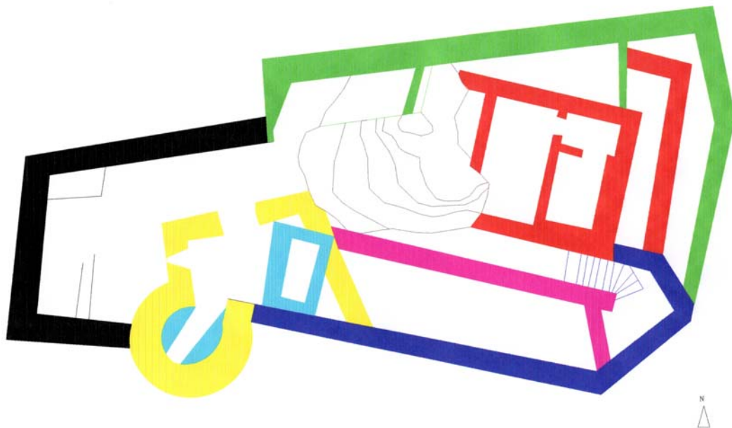
Lám. 239: castillo de los Vélez de Mazarrón. Posibles fases constructivas
