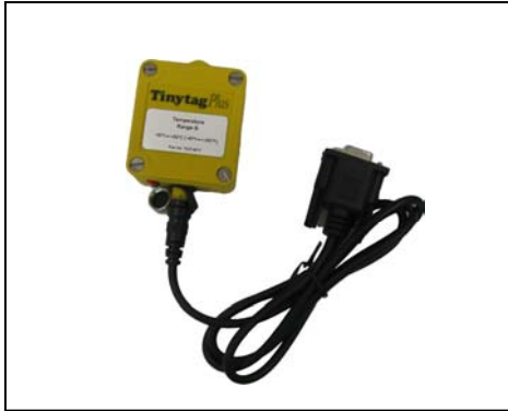
Figura 1. Registrador de temperatura (Tynitag Plus, Gemini, UK) utilizado para monitorizar la temperatura de las muestras espermáticas durante el transporte.
