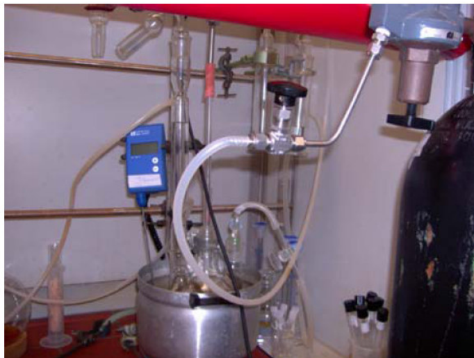
Figura 5.3. Dispositivo experimental utilizado en la síntesis de [\text{bmim}^+][\text{Cl}^-]
