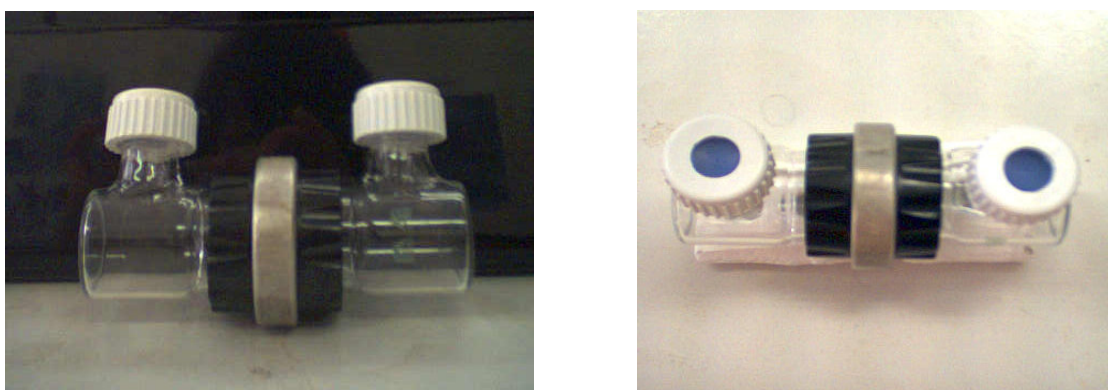
Figura 7.3. Distintas vistas de la célula de difusión utilizada en los ensayos de transporte.
