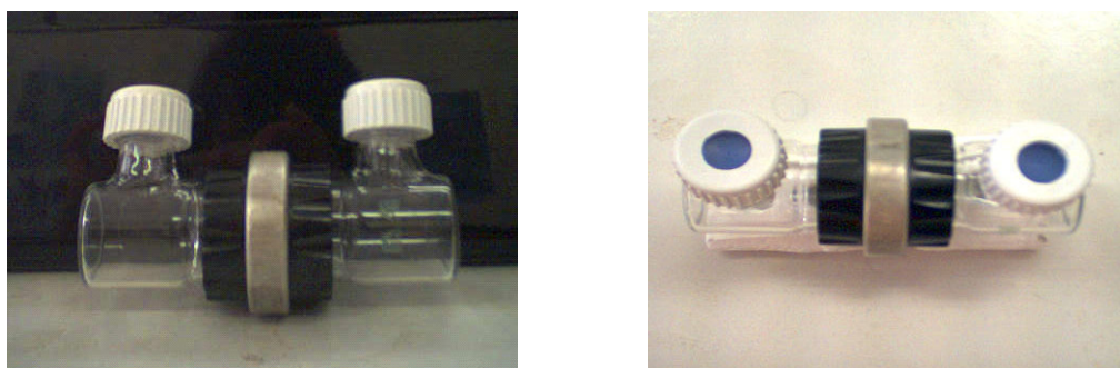
Figura 7.4. Distintas vistas de la célula de difusión utilizada en los ensayos de transporte.
