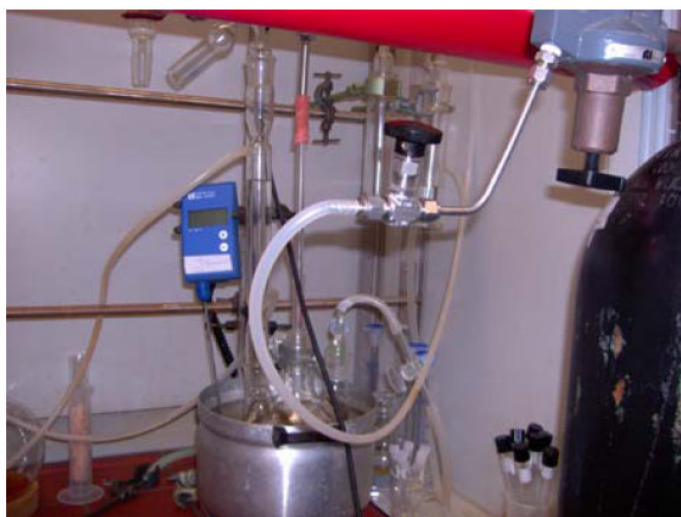
Figura 5.3. Dispositivo experimental utilizado en la síntesis de [bmim + ][Cl - ]
