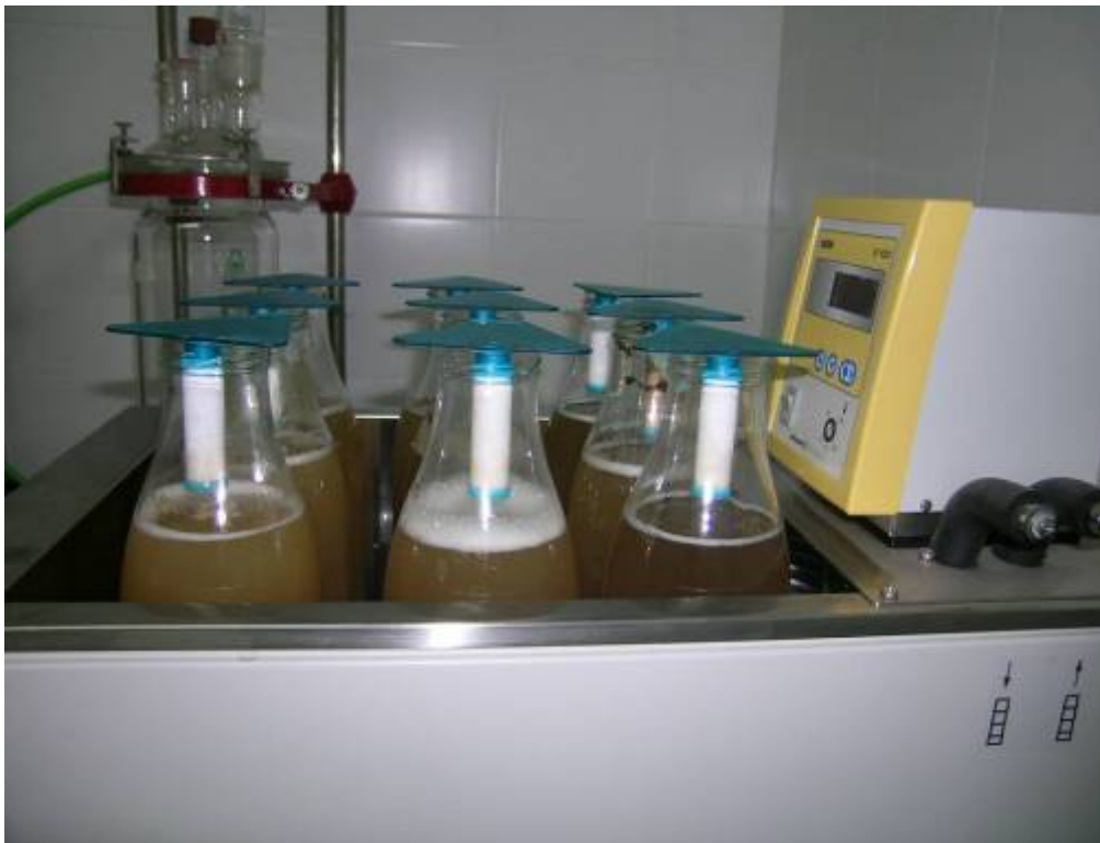
Fig. 3.11 Fermentadors d'un litre amb detectors Radiello de sulfur d'hidrogen.
