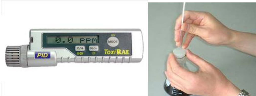
Fig. 3.10 Detector manual (RAE Systems) esquerra i columna Figasa, dreta, utilitzats per a la mesura de H_2S durant les fermentacions.
