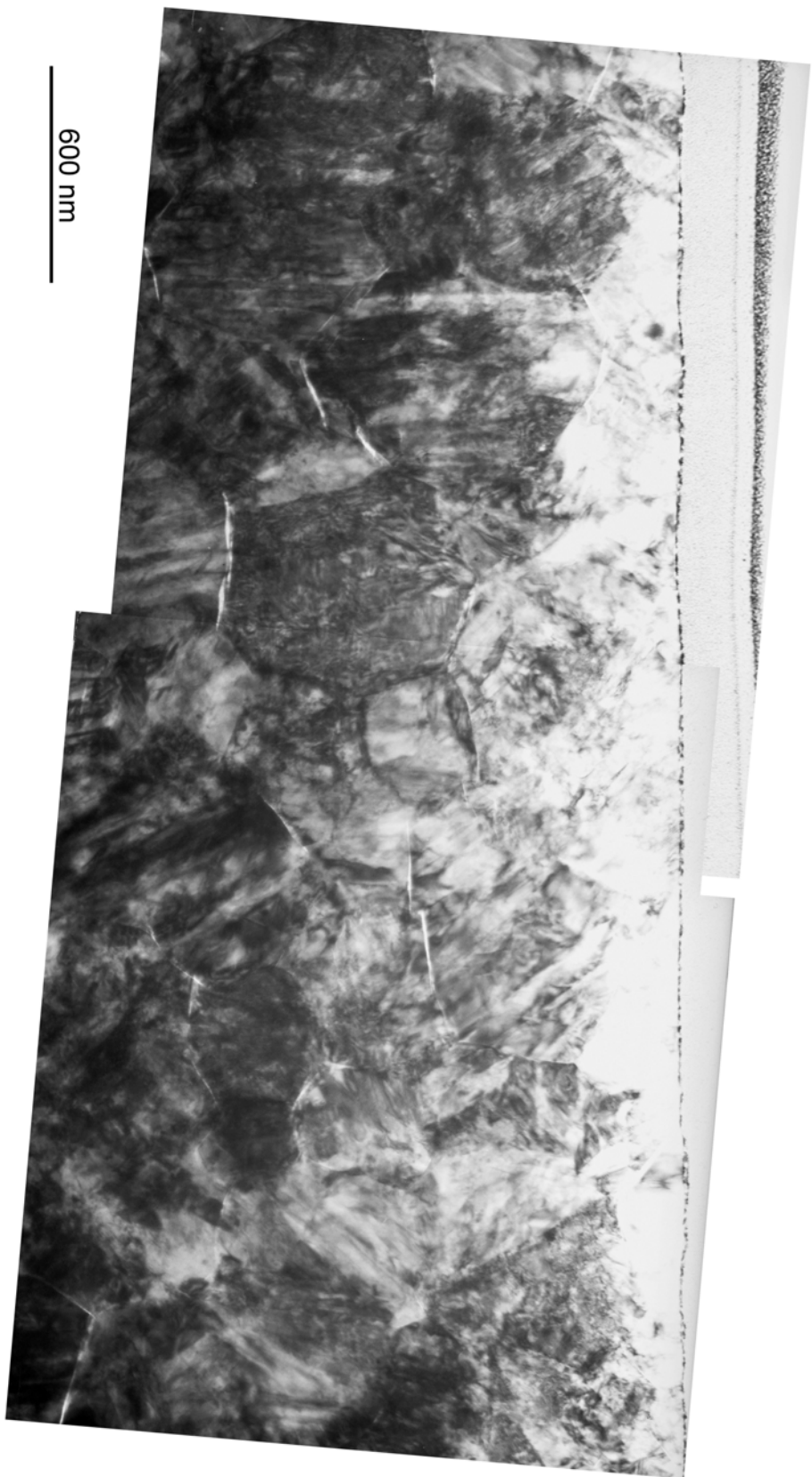
Figura 4.14. Imagen TEM del material AS degradado 60 horas. Pueden observarse los granos transformados, donde las variantes monoclinicas están orientadas preferencialmente de forma perpendicular a la superficie, mientras que las microfibrillas lo están de forma paralela a esta.
