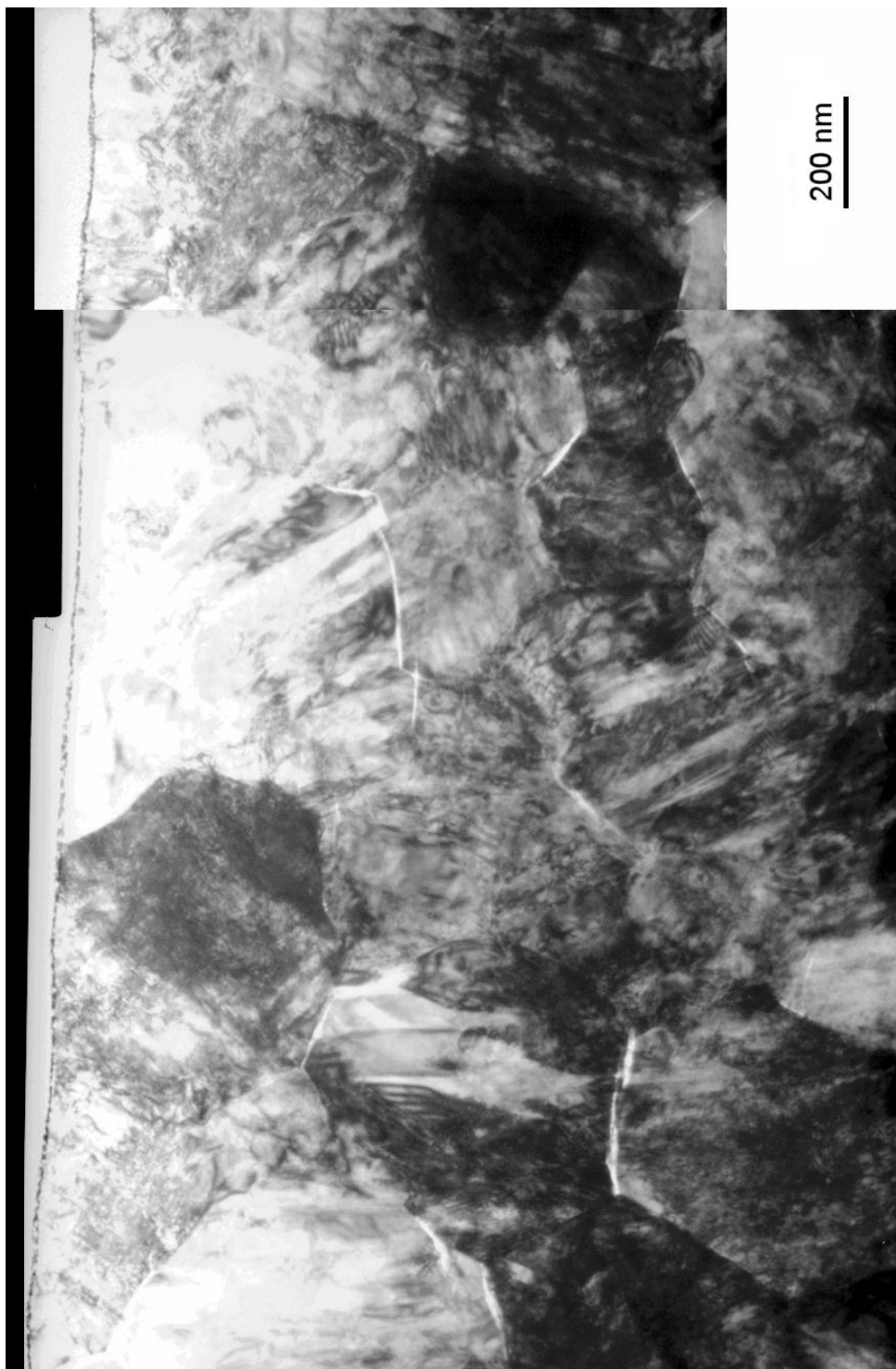
Figura 4.15. Imagen TEM del material AS degradado 60 horas a 131°C en autoclave.
