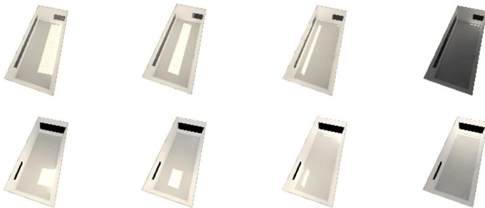
Figura 33. La figura muestra dos filas de renders durante el solsticio de verano a las 9:00, 10:00, 12:00 y 15:00 hrs. La fila superior muestra la solución diseñada por Siza y la inferior por el algoritmo genético. La simulación de iluminación combina radiosity y ray tracing usados para visualizar el resultado de la habitación de estudio en la planta 4. Ibid. 1401
