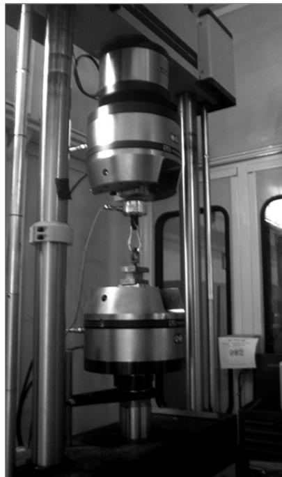
Figura 3.6 – Equipamiento para ensayo a tracción directa
