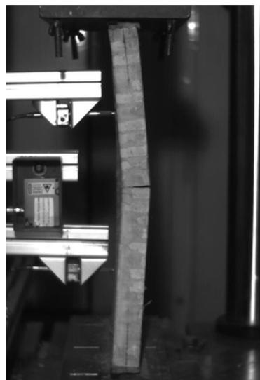
Figura 3.24 - Modo experimental de rotura para  $e = t/3$ , serie W12.
