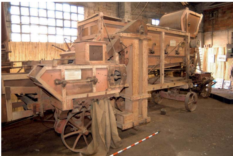
84. Màquina de batre Ajuria, amb instruccions pel seu funcionament amb plaques de llauna als laterals, de la col·lecció de l'Albert Torras de Santpedor.
