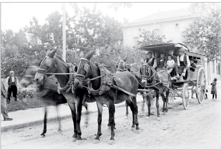
16. Diligència, estirada per cinc mulats enganxats de parell, amb tres al davant i dos al darrere, destinada al transport de viatgers a l'estació de ferrocarrils de Balenyà.
