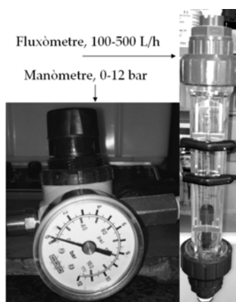
Figura 3-7 Fluxòmetre i manòmetre incorporats a la línia d'aire.
