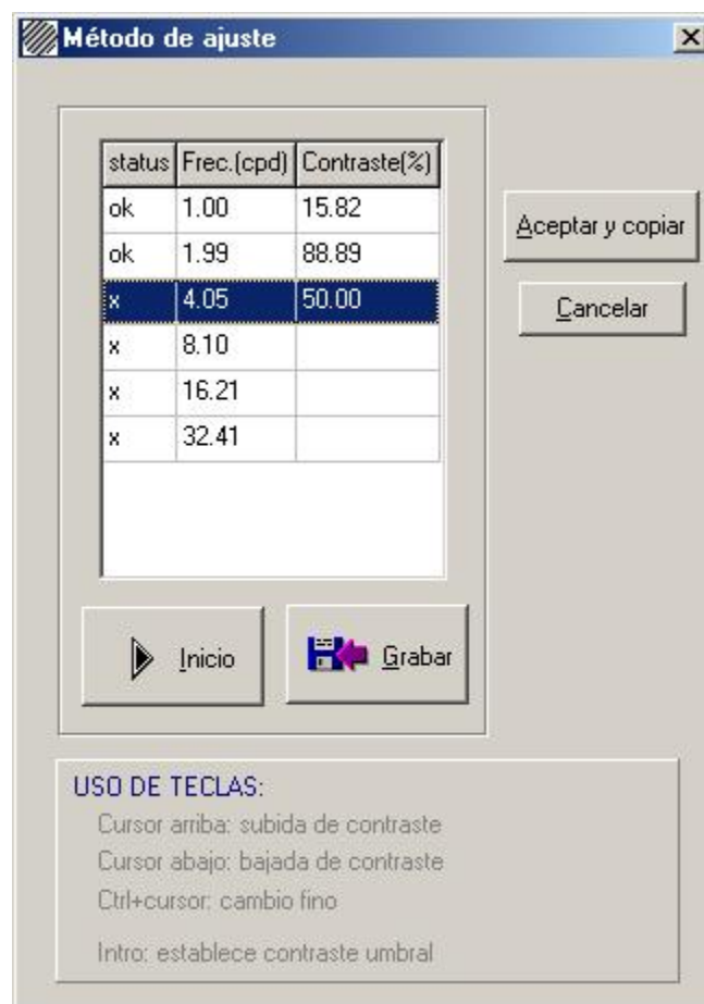
Figura 2.39: ventana de la aplicación para la medida de la CSF en el modo de ajuste.
