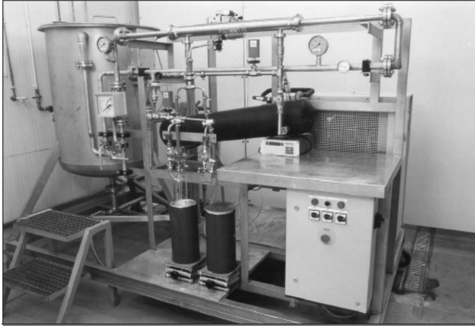
Figure 1.14. Planta piloto de PV organofílica construida por Agrotechnology & Food Innovations.
