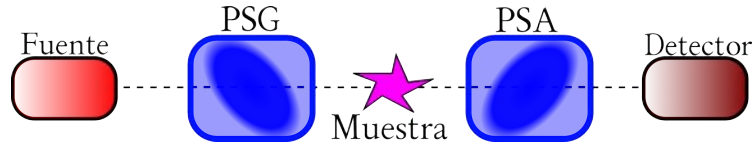
Figura 2.10: Esquema general de un dispositivo polarimétrico.
