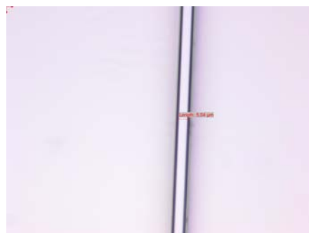
(b) Fibra depositada sobre sustrato (Microscopio Óptico, \times 100 ).
