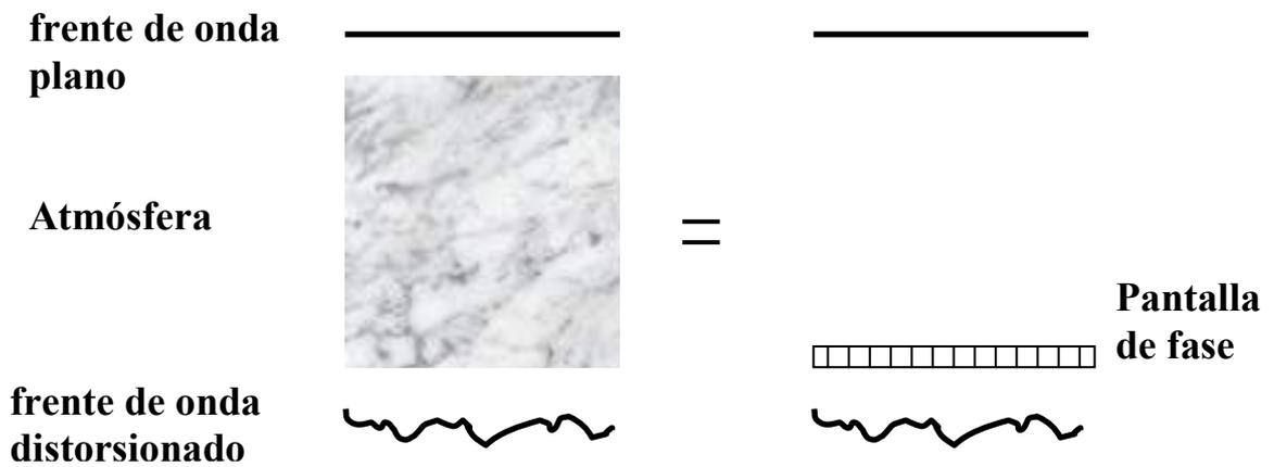
Figura 5.1 Los múltiples efectos de la atmósfera son concentrados en una pantalla de fase. El frente de onda tras atravesar esta pantalla de fase es idéntico al que se ha propagado a través de la atmósfera turbulenta.
