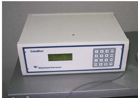
Figura 2.7 DataMan Logger. Aparato para la entrada y salida electrónica de datos del ensayo, dispone de una interfaz RS232 que permite el control por ordenador
