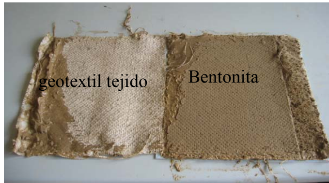
Figura 3.78 Muestra de GCL después de ser ensayada en condiciones húmedas
