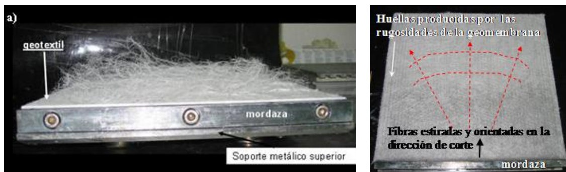
Figura 3.10 Daños observados en los geotextiles: a) GT3 b) GT1
