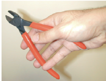
Figura 5.57: Col·locació interior del dit menovell per obrir les alicates que no disposen de sistema de retorn.
