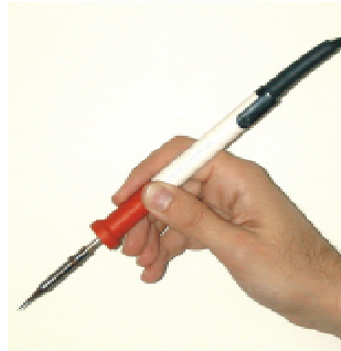
Figura 5.7: Agarrada de precisió per utilitzar un soldador.
