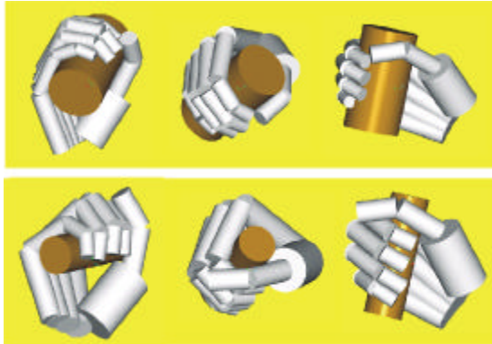
Figura 5.47: Distintes vistes de la simulació de l'agarrada cilíndrica amb dos cilindres de distint diàmetre: Les figures superiors corresponen a 38.1 mm i les inferiors a 25.4 mm.
