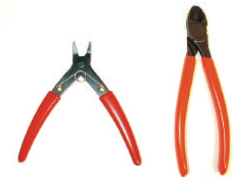
Figura 5.33: Alicates amb sistema de retorn (esquerra) i sense sistema de retorn (dreta).
