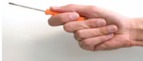
Figura 5.8: Agarrada de transició potència-precisió utilitzada per cargolar amb un tornavís menut.
