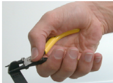
Figura 5.60: Mànec d'alicates massa menut, de forma que indueix pressions elevades a la palma.
