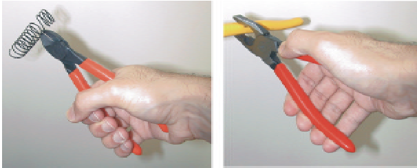
Figura 5.56: Canvi de les zones de contacte amb l'augment de l'obertura dels mànecs de les alicates.
