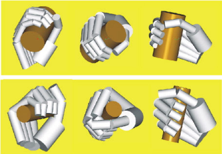
Figura 4.81: Distintes vistes de la simulació de l'agarrada cilíndrica amb dos cilindres de distint diàmetre: Les figures superiors corresponen a 38.1 mm i les inferiors a 25.4 mm.
