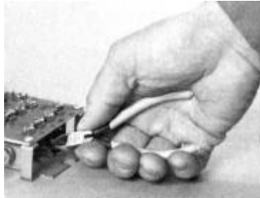
Figura E.7: Alicates amb mànec massa curt, de forma que s'indueix una concentració de pressions indesitjable en la palma.
