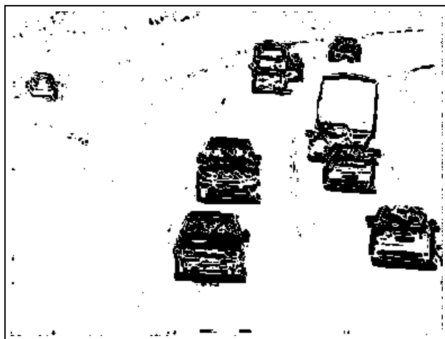
Figura 3.8: Imagen diferencia obtenida a partir de la imagen de la figura 2.1 y la siguiente de su misma secuencia.
