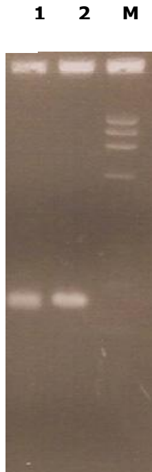
Figura 7. Detecció del gen ureA d' H. pylori soca SS1 per PCR semiimbricada en gel d'agarosa al 3%. 1: 1 µl amplicó 411 pb amb iniciadors HPU2 i HPUI1; 2: 10 µl amplicó 411 pb amb iniciadors HPU2 i HPUI1; M: Marcador d pes molecular ØX174.
