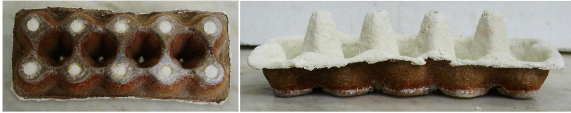
Figura V.94. Detalle del proceso: desarrollo de la pieza de cascarilla cerámica.
