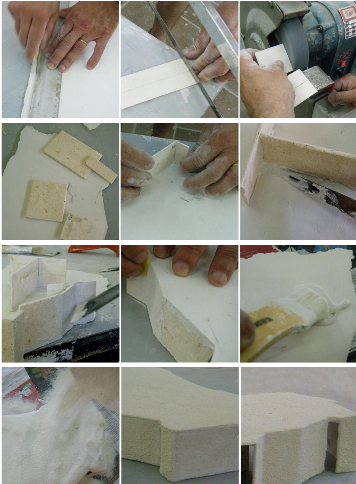
Figura V.173. Procedimiento de construcción de la pieza.
