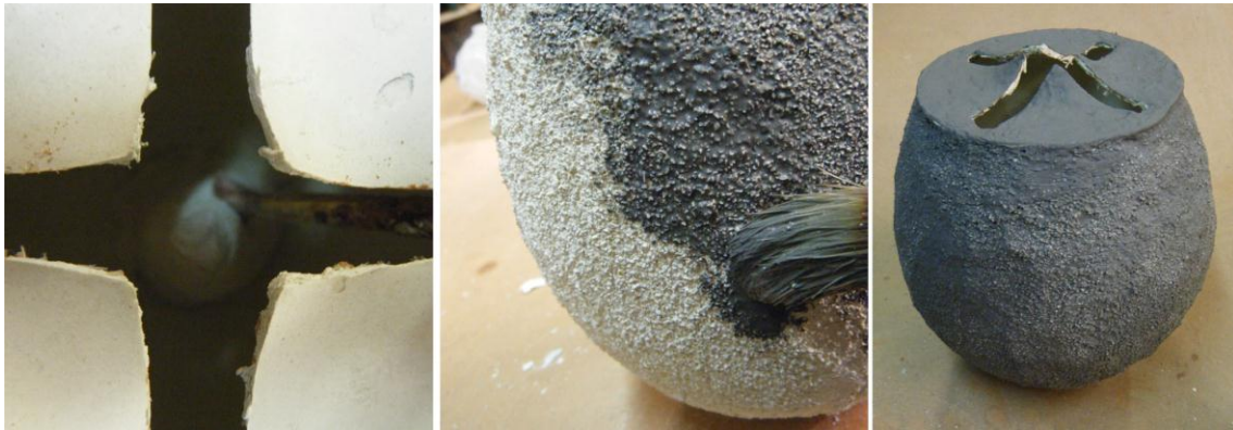
Figura V.19. Proceso de aplicación del vidriado.
