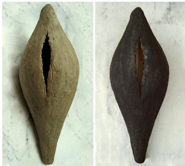
Figura V.73. Caparazón cocido a 750°C (izquierda), y cocido a 1000°C (derecha).
