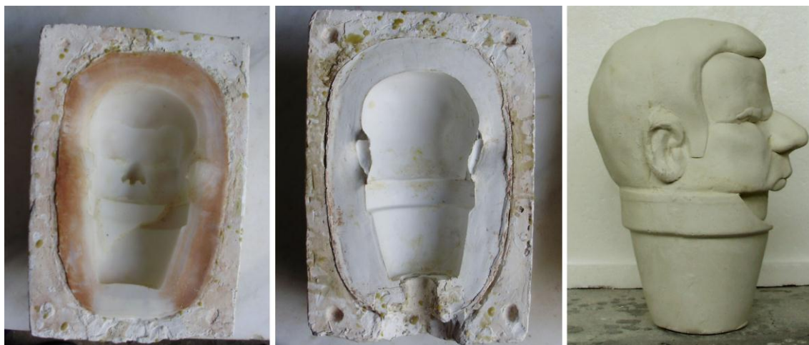
Figura V.111. Detalle del proceso: desarrollo de la pieza de cascarilla cerámica.
