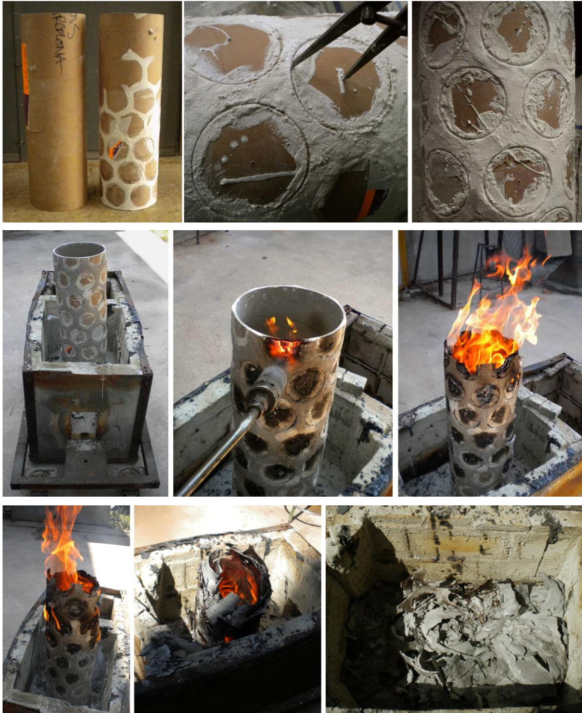
Figura III.80. Procedimiento de quemado del cartón y destrucción de la pieza en cascarilla.
