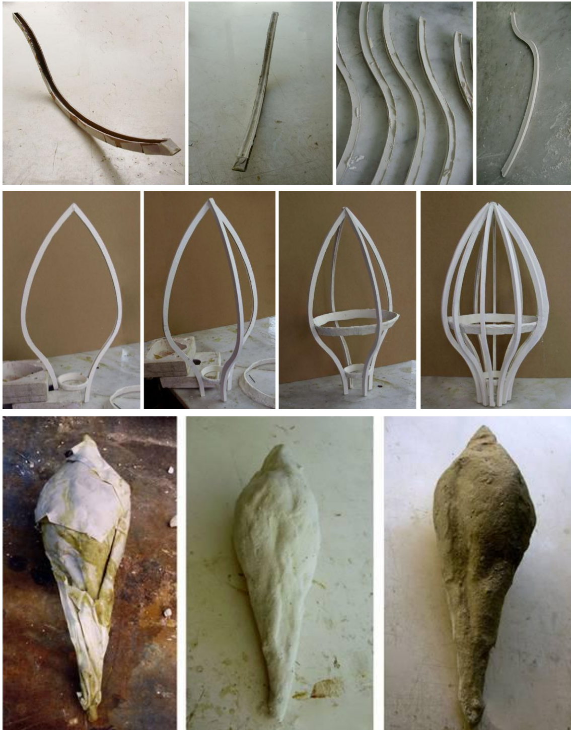
Figura V.113. Procedimiento de construcción de la pieza mediante encofrado.
