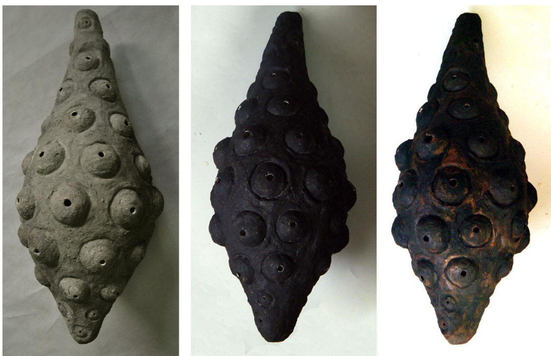
Figura V.69. Cocción a 750°C (izquierda), cocción a 1000°C (centro), modificación de la superficie con soplete de gas butano (derecha). Tamaño de la pieza 80,8 x 26,8 x 26,8 cm.
