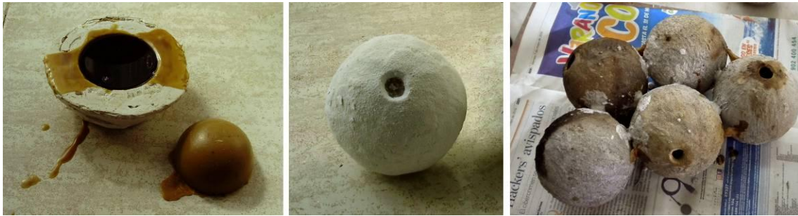
Figura V.43. Procedimiento de realización de las esferas (izquierda y centro) y unión de las esferas mediante papilla con limadura (derecha).
