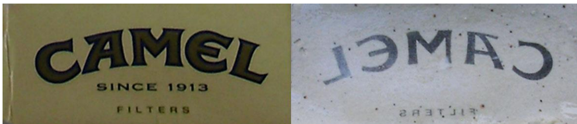
Figura IV.83. Imagen original (izquierda) y transferida (derecha) sobre la superficie de la cascarilla cerámica después de la cocción.
