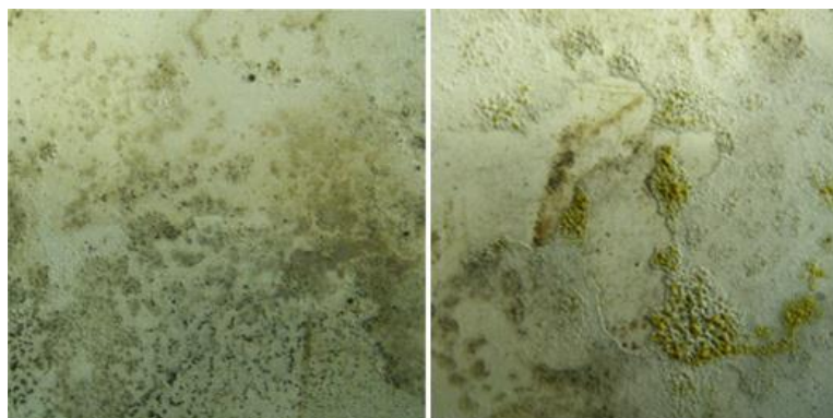
Figura IV.90. Gradación de color de la solución sobre la superficie lisa de la cascarilla cerámica.
