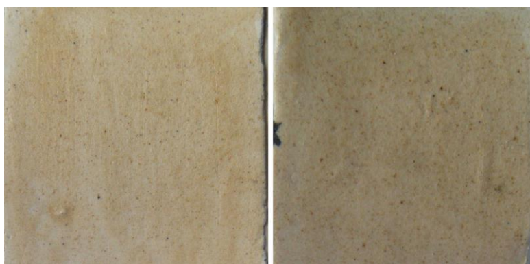
Figura IV.68. Engobe de óxido de manganeso mezclado con agua destilada (izquierda) y mezclado con sílice coloidal (derecha).
