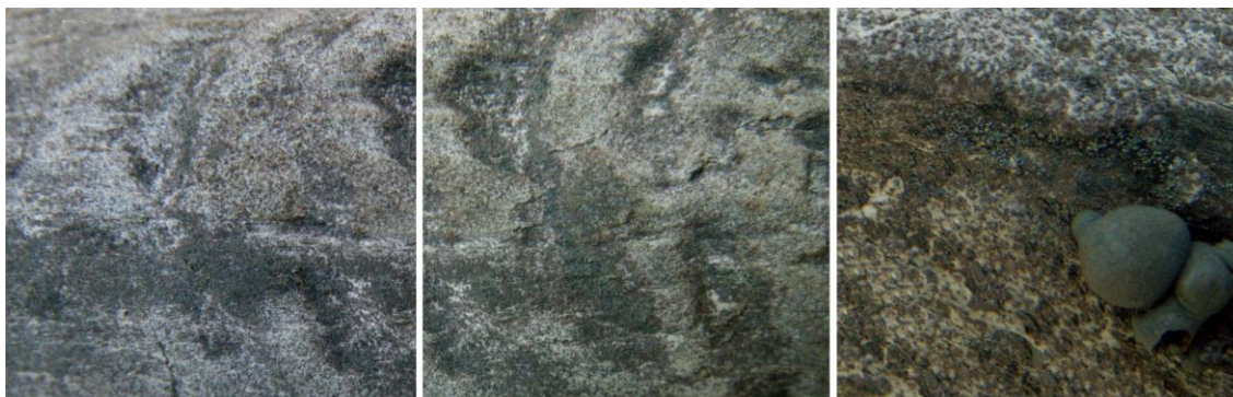
Figura IV.41. Plaqueta cocida a 750°C (izquierda); plaqueta cocida a 875°C (centro); plaqueta cocida a 1200°C (derecha). En esta última foto se aprecian zonas de acumulación de hierro (realizada con molde de silicona).
