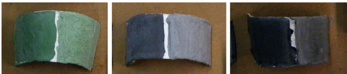
Figura IV.55. Diferencias entre los vidriados preparados con sílice (izquierda) y agua destilada (derecha).
