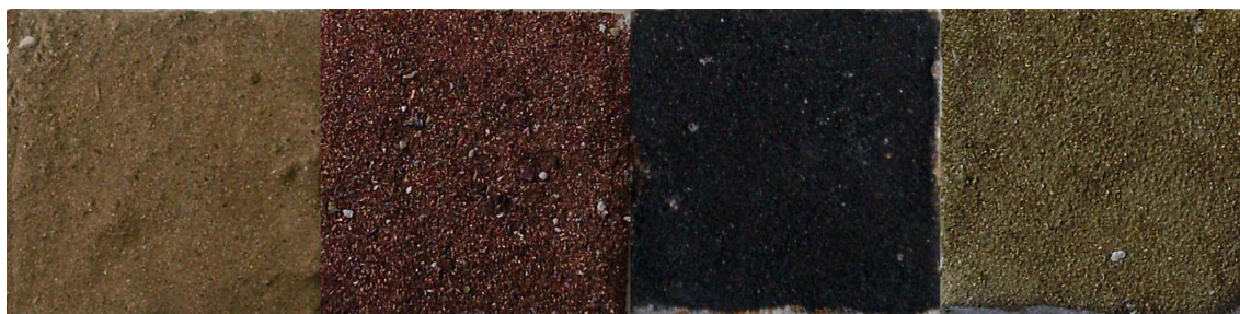
Figura IV.35. Rebozado de bronce, cobre, hierro y latón aplicados después de la cocción.
