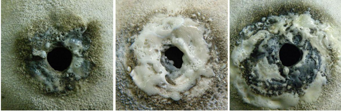
Figura IV.101. Detalle de las esferas, parte fundida por soplete de soldadura acetilénica.
