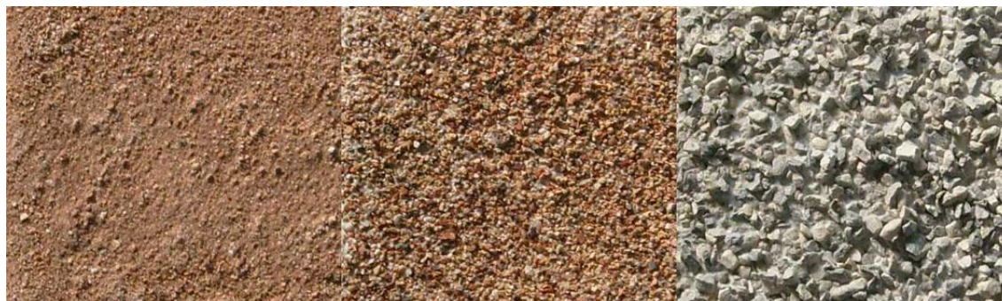
Figura IV.20. Chamota de diferente granulometría (1-4 mm.) utilizada como rebozado; en la muestra de la derecha se utilizó combinación de granulometrías.
