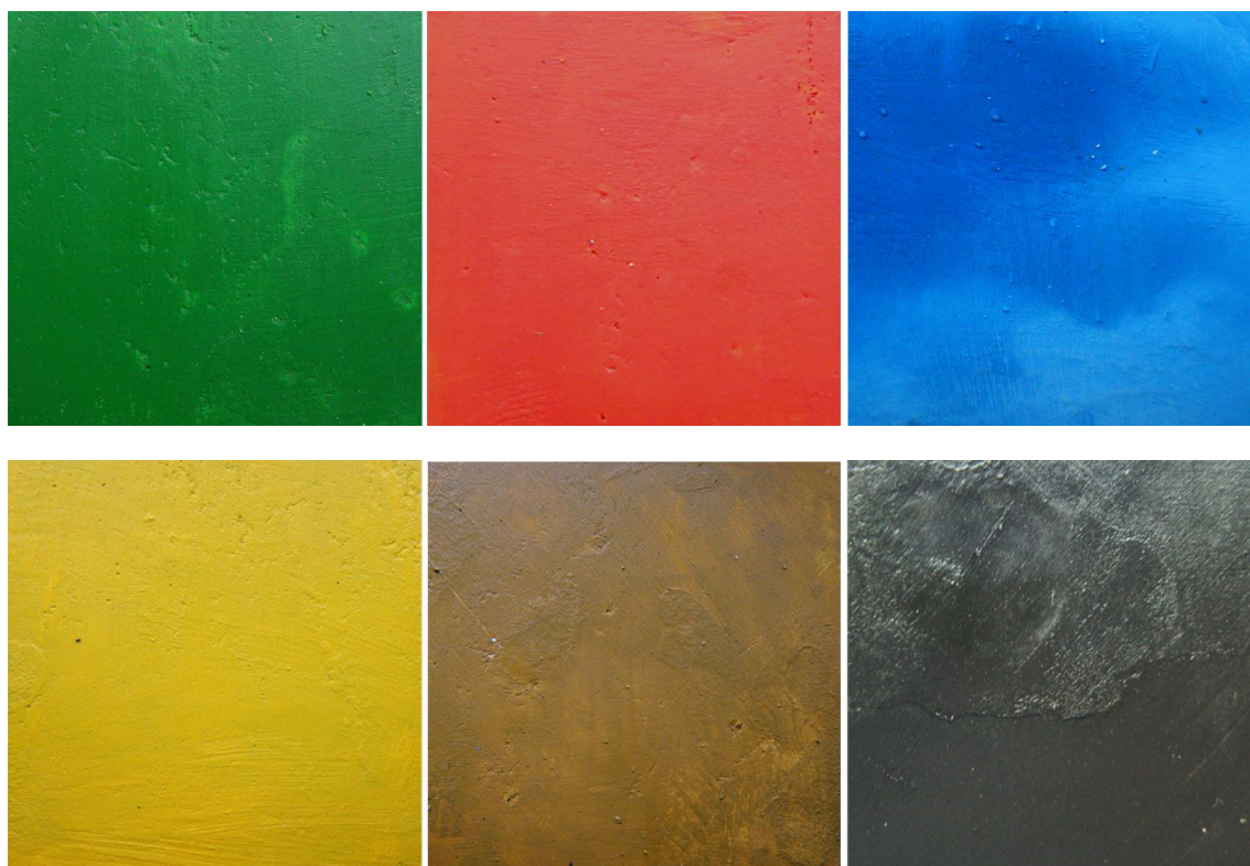
Figura IV.77. Distinta coloración mediante color al óleo sobre la superficie lisa de la cascarilla cerámica.
