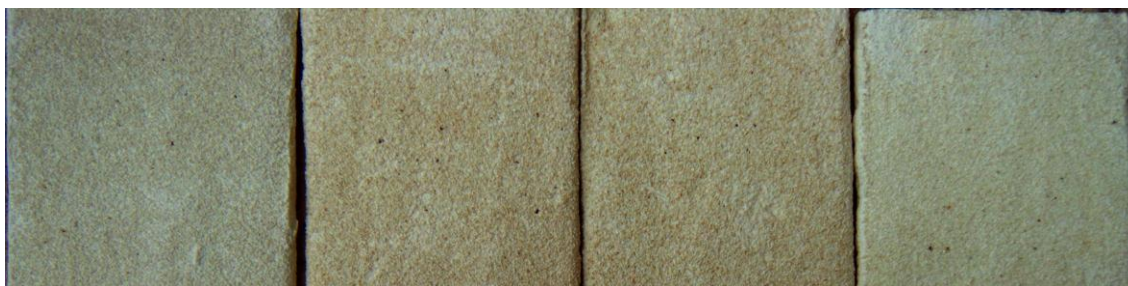
Figura IV.4. De izquierda a derecha, aspecto de la superficie exterior con rebozado Moloquita 50-80dd sometida a cocción de 750°C, 875°C, 1000°C 1200°C respectivamente.
