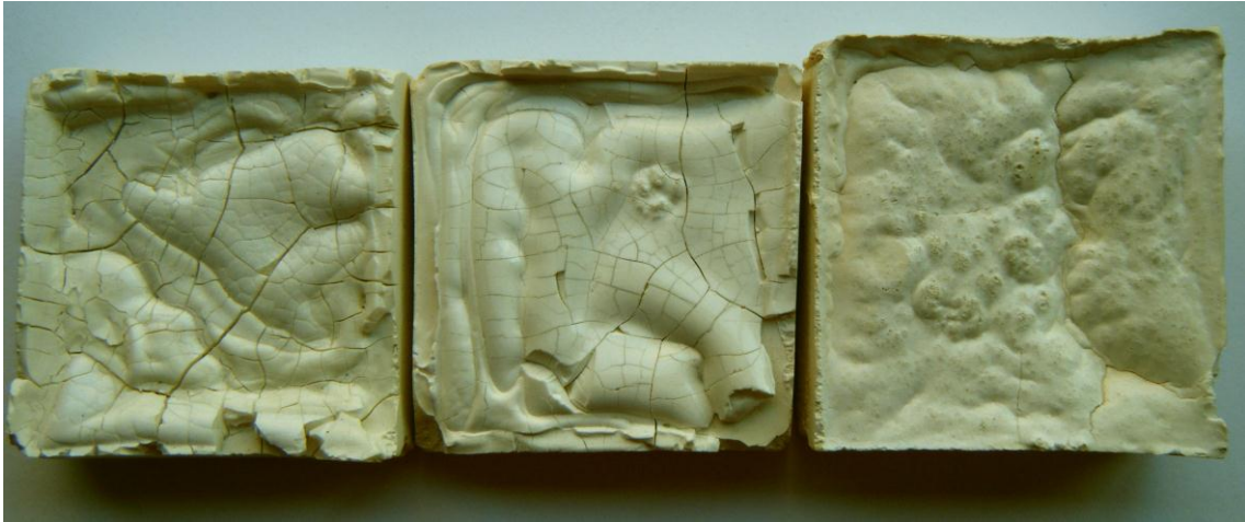
Figura IV.8. Craquelados obtenidos respecto a las distintas composiciones de PW 50 y Moloquita -200. De izquierda a derecha: 45-55%, 40/60% y 35/65%.
