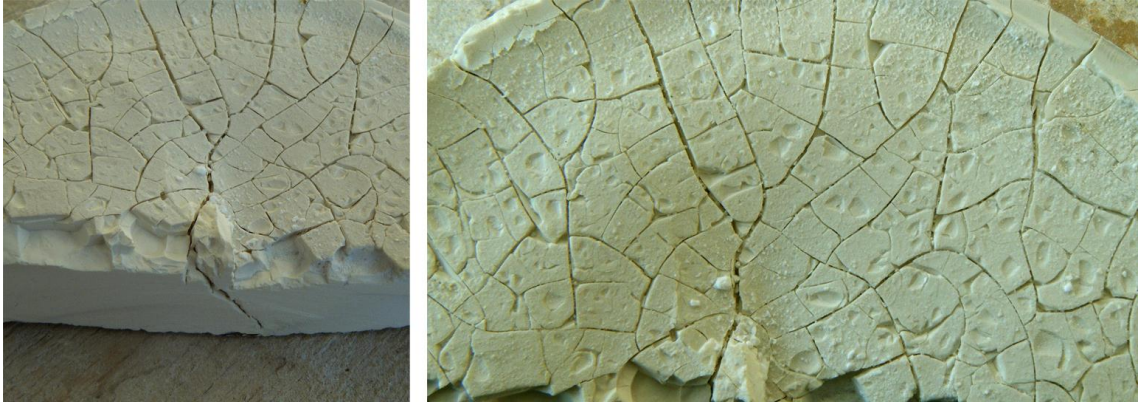
Figura IV.10. Marca de la sílice coloidal y grietas que dejó sobre la superficie del bloque.
