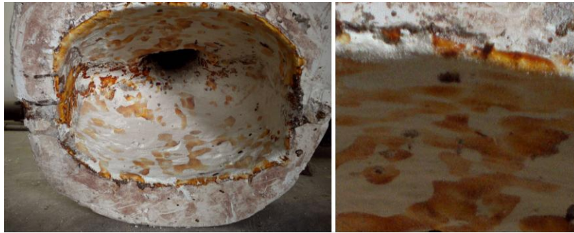
Figura IV.38. Manchas de óxido en el molde de escayola.
