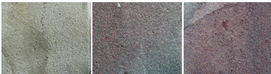
Figura IV.96. Gradación de color de la solución sobre la superficie granulada de la cascarilla cerámica.
