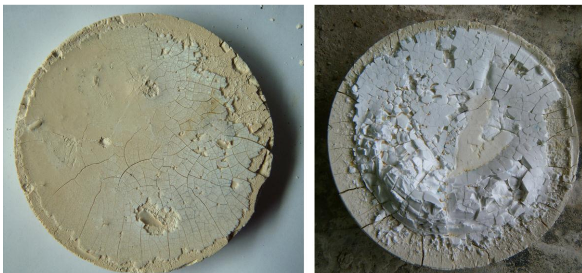
Figura IV.6. Papilla de PW 50 y Moloquita -200. Izquierda composición de 35/65%. Derecha composición 50-50%.
