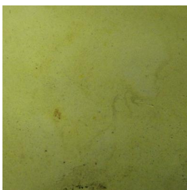
Figura IV.51. Alteración de la cascarilla cerámica mediante ácido clorhídrico (capa reverso de la cascarilla cerámica, sin aportación de limadura de hierro).
