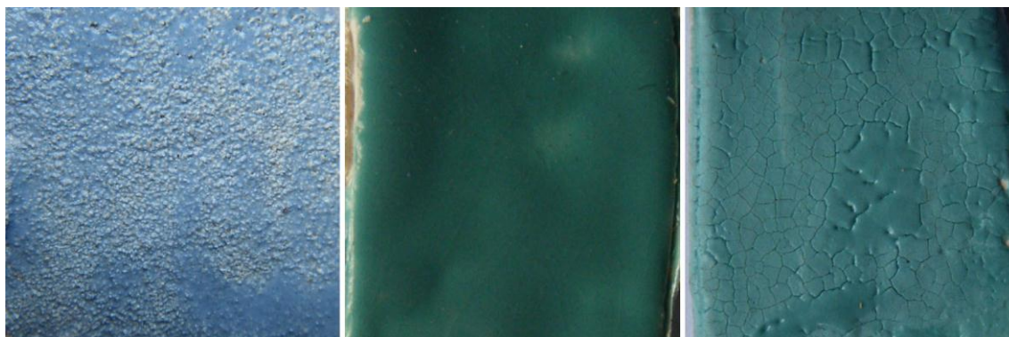
Figura IV.57. Vidriado nº 4319 mezclado con agua destilada aplicado sobre el rebozado (izquierda) y superficie lisa (centro). Vidriado nº 4319 mezclado con sílice coloidal (derecha)
