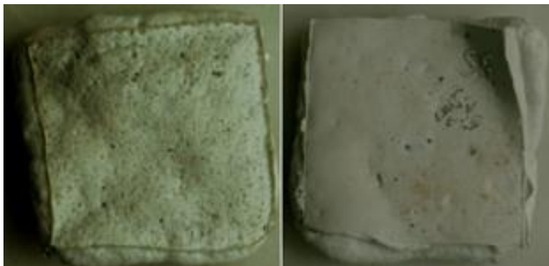
Figura IV.13. Carsil 9 después de la cocción, superficie exterior (izquierda) y superficie de contacto (derecha).
