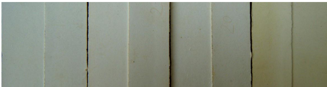
Figura IV.5. De izquierda a derecha, aspecto de la capa de contacto en papilla de composición 35-56% sometida a cocción de 750°C, 875°C, 1000°C 1200°C respectivamente.
