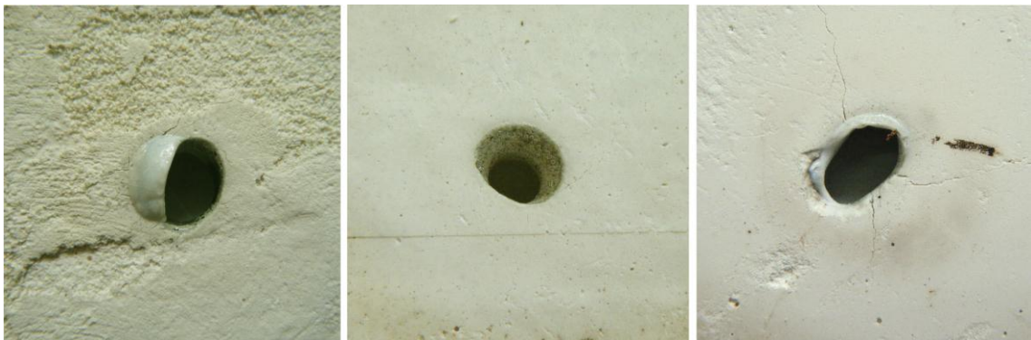
Figura IV.104. Plaqueta 6x6cm. Superficie opuesta a la aplicación de la llama del soplete de soldadura acetilénica.
