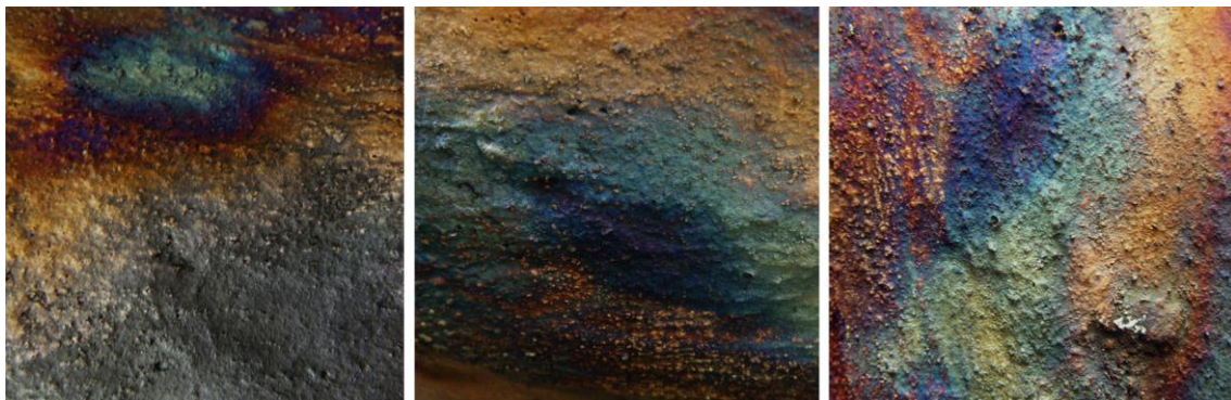
Figura IV.46. Plaqueta de bronce cocida a 1000°C y modificada con autógena.
