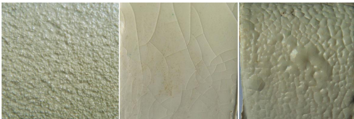
Figura IV.56. Vidriado Plumic transparente mezclado con agua destilada aplicado sobre el rebozado (izquierda) y superficie lisa (centro), Plumic transparente mezclado con sílice coloidal (derecha).
