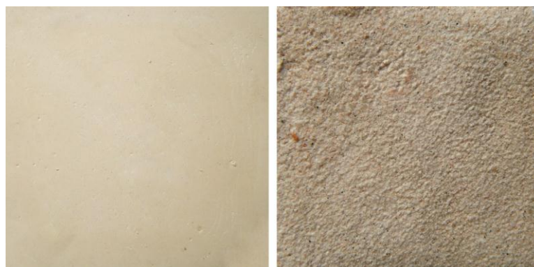
Figura IV.16. Papilla de circón capa de contacto (izquierda); rebozado de circón (derecha).
