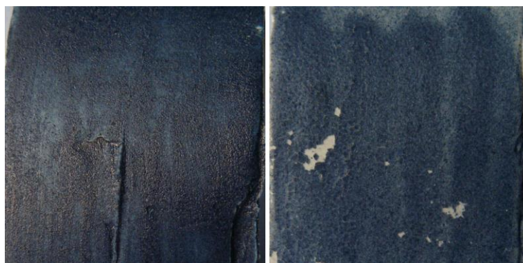
Figura IV.66. Engobe de óxido de cobalto mezclado con agua destilada (izquierda) y mezclado con sílice coloidal (derecha).
