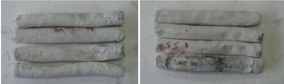
Figura IV.11. Ensayos de probetas cilíndricas (20 x 2cm, y espesor de 2mm), donde se observa la deformación sufrida en ambas pruebas después de la cocción del material a 750°C.
