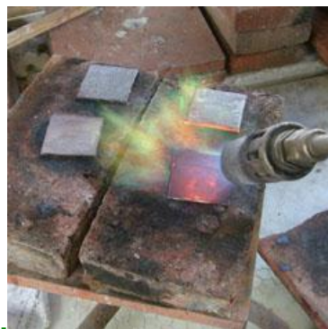
Figura IV.29. Proceso de calentamiento de la papilla con limaduras metálicas sobre cascarilla cerámica previamente cocida.
