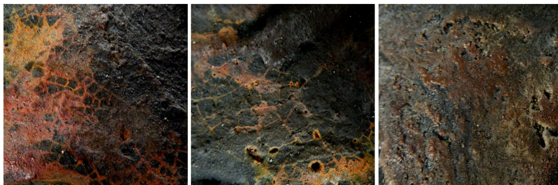
Figura IV.47. Plaqueta de bronce cocida a 1000°C y modificada con soplete a gas.
