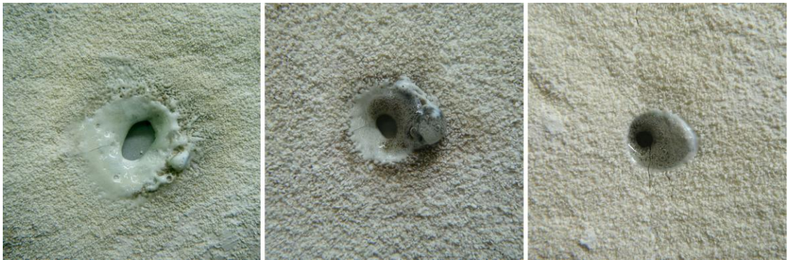
Figura IV.102. Plaqueta 6x6 cm. Parte fundida por soplete de soldadura acetilénica sobre la superficie rebozada.
