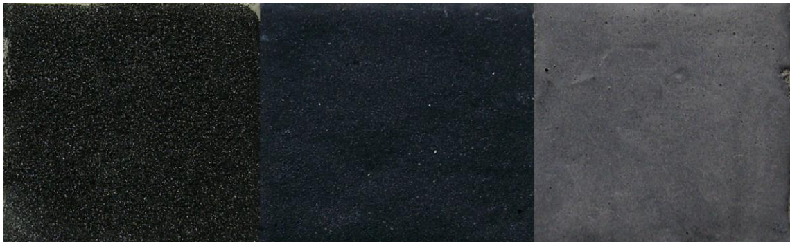
Figura IV.17. Carborundo de distintas granulometrías: 100dd (izquierda) y 20dd (centro). Papilla con introducción del carborundo (derecha).
