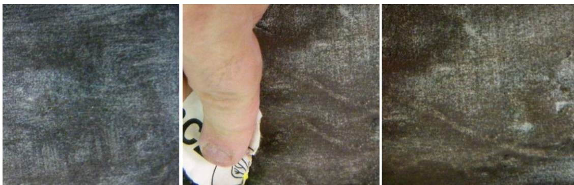
Figura IV.49. Aparición del óxido de hierro tras limar la superficie de la pieza.
