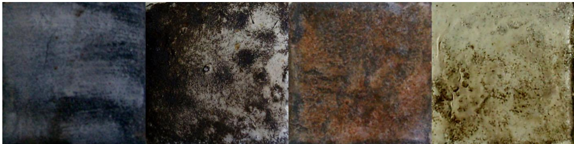
Figura IV.27. Aspecto de la superficie exterior conteniendo limaduras metálicas. De izquierda a derecha: mezcla de bronce, cobre, hierro y latón después de la cocción.
