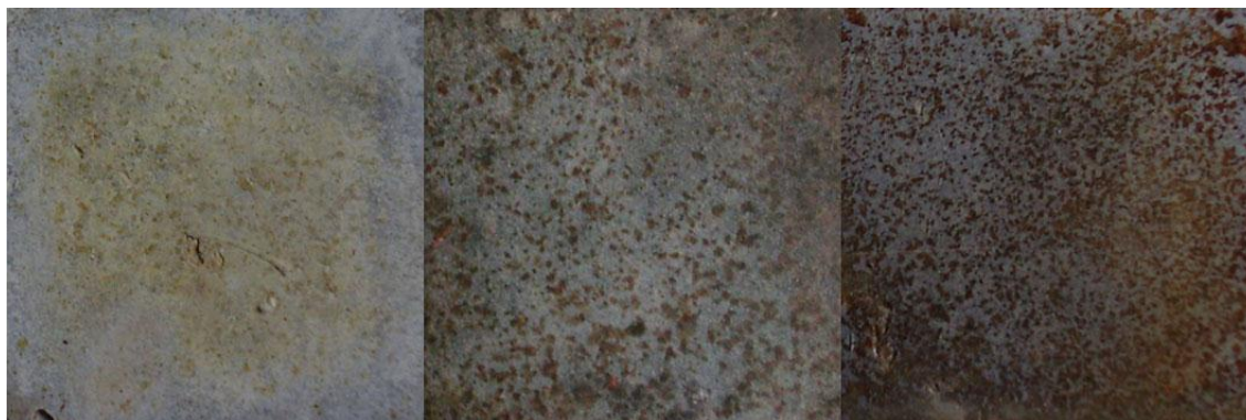
Figura IV.25. Resultados obtenidos de izquierda a derecha: 1ª, 2ª y 3ª mezclas, tras la incorporación de limaduras de bronce y hierro en diferentes porcentajes.
