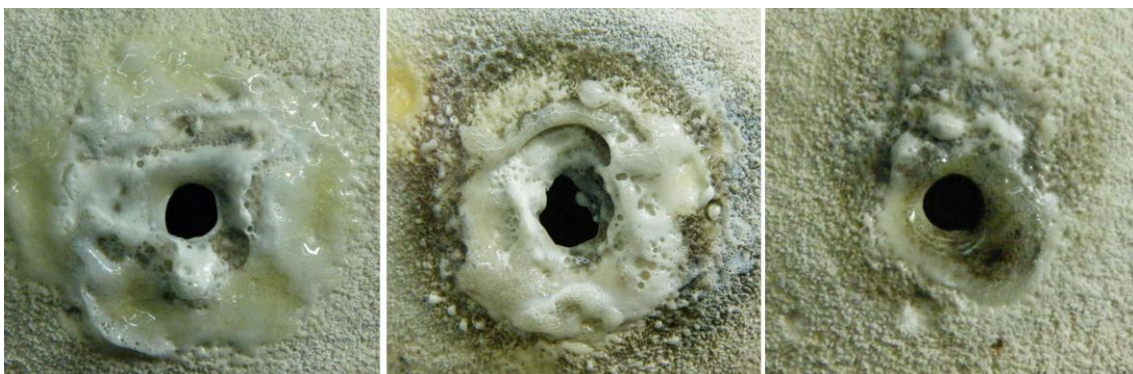
Figura IV.100. Alteración de la superficie de esferas mediante soplete de soldadura acetilénica.
