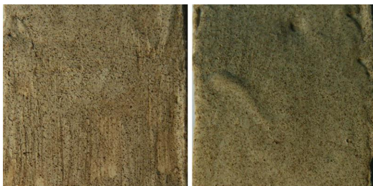
Figura IV.71. Engobe con Moloquita de manganeso mezclado con agua destilada (izquierda) y mezclado con sílice coloidal (derecha).
