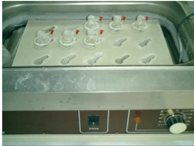
Fig. 3.3. Sistema termostático provisto de agitación magnética con capacidad para 15 celdas, en el que se puede observar seis celdas de difusión
