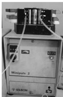
Figura 24. Bomba peristáltica Minipuls 2 de Gilson.
