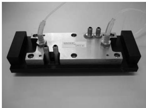
Figura 17. Celda ATR horizontal de flujo de Graseby-Specac. La disolución circula por un espacio mínimo entre el cristal de ZnSe y la placa metálica superior.
