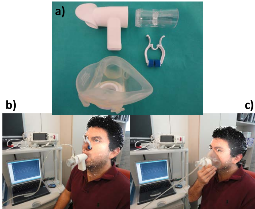
Figura 2-5. Neumotacómetro: a) boquilla, pinza nasal y mascarilla; b) neumotacómetro usando boquilla y pinza nasal; y c) usando mascarilla.
